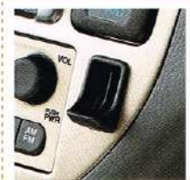
●コインホルダー 高速料金所などのおつりは、ここにキープ。
