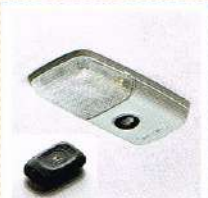
●キーレスエントリーシステム キーを差し込まずに、ドアの施錠・開錠ができます。ウエルカムランプ機能付。(Bタイプ、Gタイプを除く)
