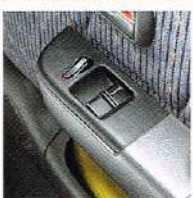
●フロントパワーウィンドウ 窓の開閉を、手もたで簡単操作できます。(Bタイプを除く) Photo: 3ドア Lタイプ
