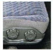
●運転席前後独立式ハイトアジャスター チルトステアリングとあわせて、ポジションをもめ細かに調整できます。(Lタイプ、スポルティックT5タイプに標準装備)
