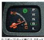
シフトレバーモード時には、Sモードインジケータが点灯します。
