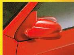
●ボディ同色電動格納式リモコンドアミラー
