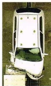
テスト車両によるオフセット衝突実験
