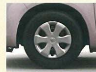
155/80R13タイヤ&13x4.50B スチールホイール (樹脂ホイールキャップ)
