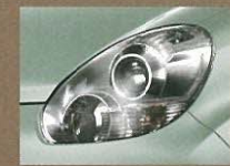
プロジェクター式ハロゲンヘッドランプ (ロービーム) [マニュアルレベリング機能付]
