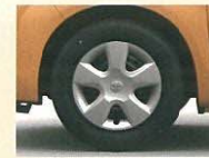
165/70R14タイヤ&14x5J スチールホイール (樹脂ホイールキャップ)
