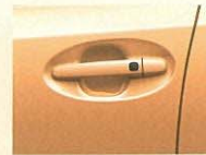
グリップ式カラードアウトサイドドアハンドル (ボディ同色)
