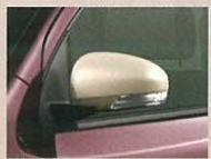
サイドターンランプ付電動格納式リモコンアミラー (シャンパン塗装)
