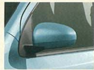
電動格納式リモコンカラードアミラー (リバーズ運動機能付 [助手席側]・ボディ同色)
