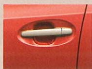
グリップ式アウトサイドドアハンドル (シャンパン塗装)
