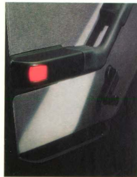
Iedere armsteun is aan de achterzijde voorzien van een reflector om bij geopend portier het achteropkomend verkeer te waarschuwen.
