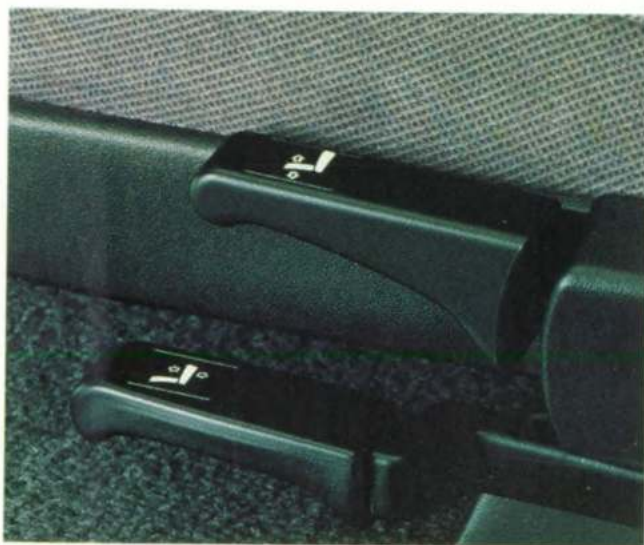
Met de handverstelhefbomen kan de stoelrugleuning traploos vermeld worden en is tevens de hoogte van de stoelzitting te regelen.
