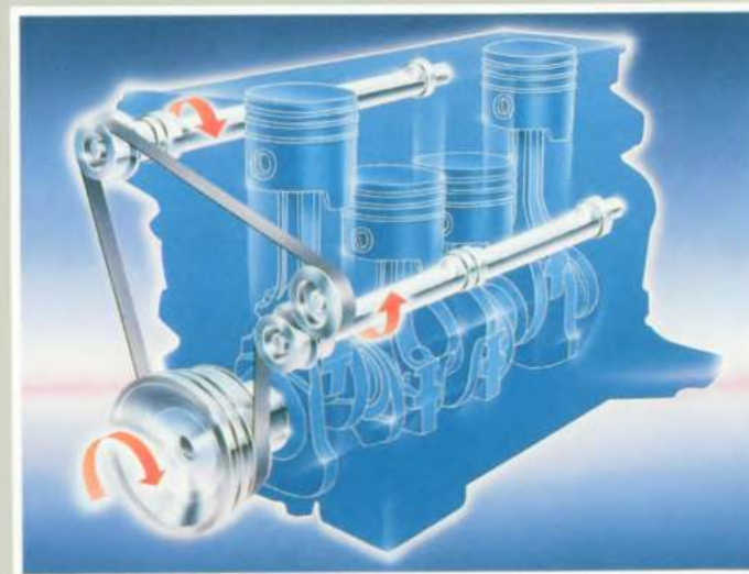
Schema van de werking van de balansassen.
