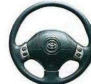
本革巻きステアリング [電子制御式4速オートマチック車] ステアリングスポーク部の 表側にシフトダウン、 シフトアップスイッチを配置。
