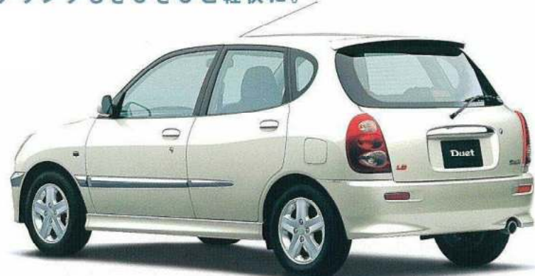
Photo:1.35。内装色はダークグレー。 ● K3-VE2エンジン(4気筒1.3ℓ DOHC16バルブVVT-i) ボディカラーのパールホワイト(W16)はメーカーオプション。 ● 室内の写真は機能説明のためにボディの一部を切断したカットモデルです。
