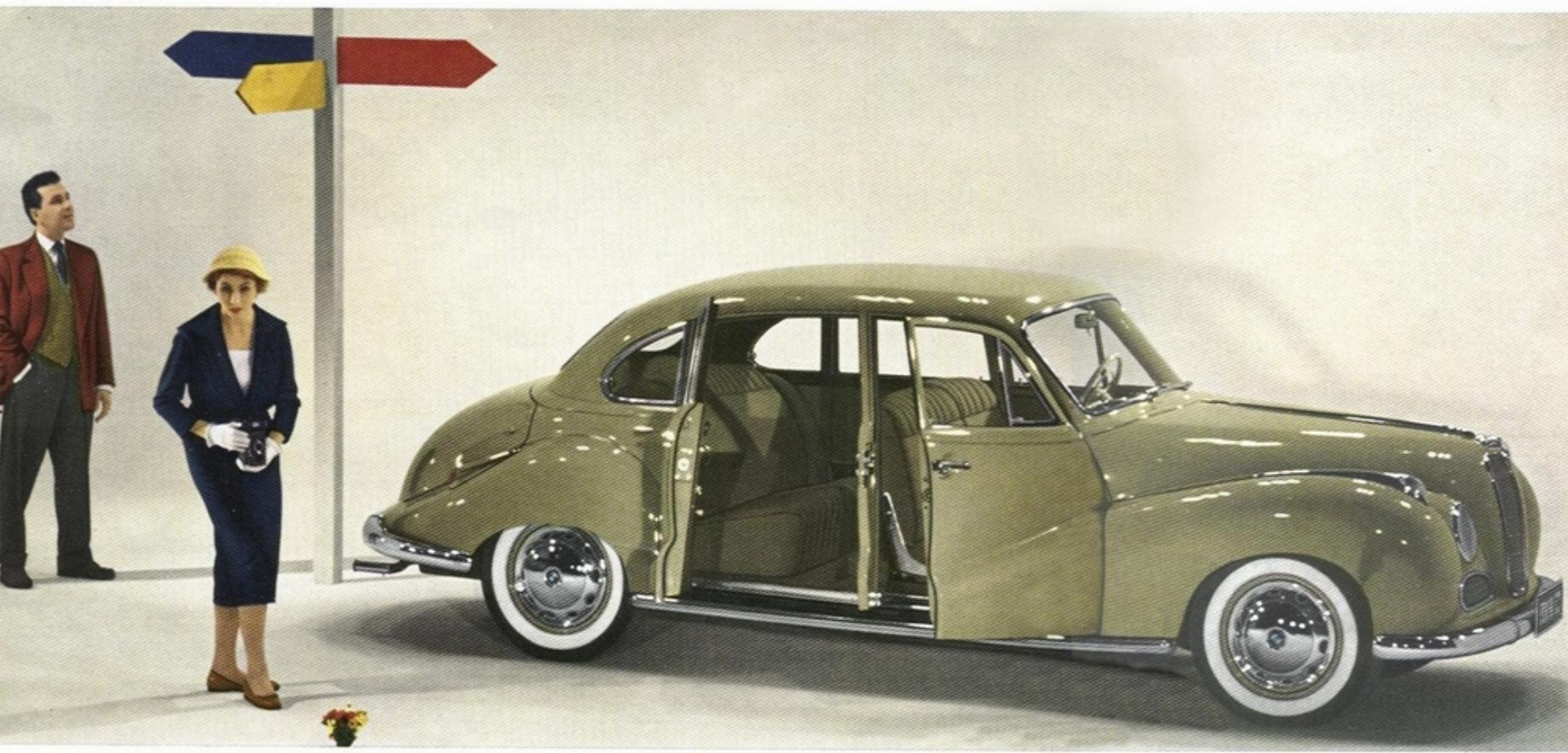
**Sekscylindret.** I denne gennemprovede BMW-model har man skabt den komfortable og hensigtsmæssige rejsevogn med en tophastighed på ca. 145 km/t. Den smidige sekscylindrede motors cylindervolumen er nu forøget til 2.1 liter (72 HK). Ved hjælp af ændret bagtøjsudveksling har dette smukke automobil nu fået forbedret sine accelerationsegenskaber til et maximum.
