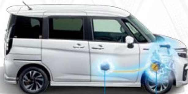
專用鋰離子電池 ISG (內置式電動摩打·附設發電機)
