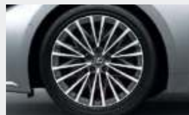
245/45R20ランフラットタイヤ & ノイズリダクションアルミホイール (切削光輝+ダークグレーメタリック塗装)
