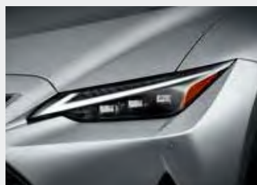
三眼フルLEDヘッドランプ(ロー・ハイビーム)& LEDフロントターンシグナルランプ
