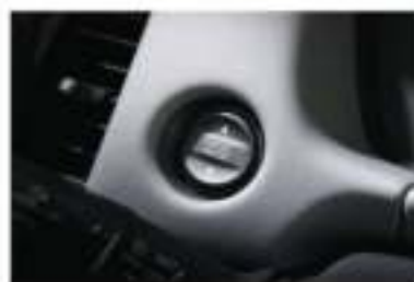
ドライブモードスイッチ (NORMAL モード、SPORTモード、ECONモード) (e:HEV RS専用)
