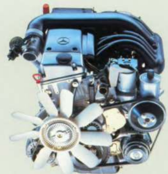
Een 2,5 liter vijfcilinder dieselmotor met vierkleppen-techniek.
