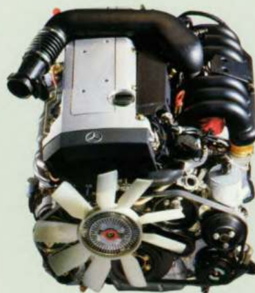
De zescilinder motor van de C 280.
