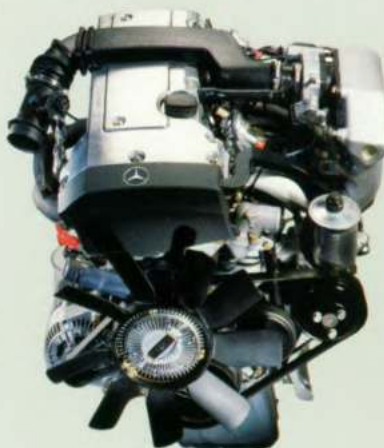
De viercilinder motor van de C 220.
