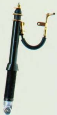
De niveauregeling zorgt voor een konstant wagen-niveau.
