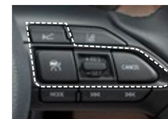
レーダークルーズコントロール/ 車間距離切替スイッチ
