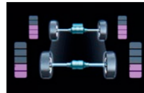
マルチインフォメーションディスプレイ内の前後輪トルク配分量表示
