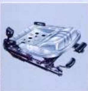
Stoelen die voorkomen dat de inzittenden bij een aanrijding onder de gordel doorschuiven.
