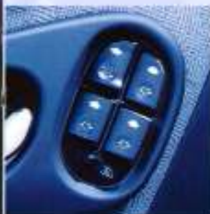
Elektrisch bediende ruiten voor en achter met blokkering voor de ruiten achter en verlichte handgrepen.
