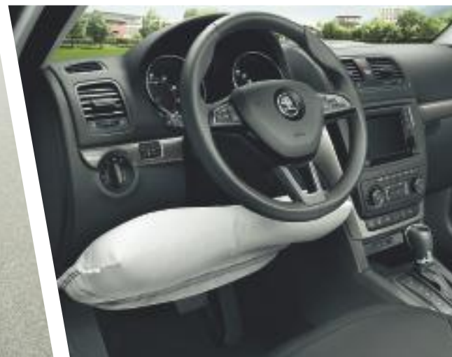
L'airbag per le ginocchia, lato conducente, protegge dagli urti contro la parte inferiore del cruscotto.
