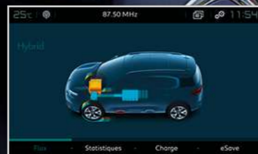
Energiestromen: geeft de werking van het hybridesysteem weer.
