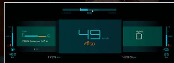
Modus "Meters": voor de weergave van de informatie die betrekking heeft op het rijden in de modi Electric/Hybrid/Sport.
