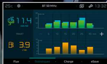
Statistieken: overzicht van uw elektrische verbruik en brandstofverbruik om u te helpen nog zuiniger te rijden.
