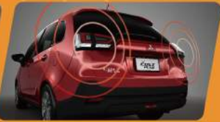
ESS智慧型緊急煞車警示系統 緊急煞車時方向燈快速閃動，警告後方來車避免追撞
