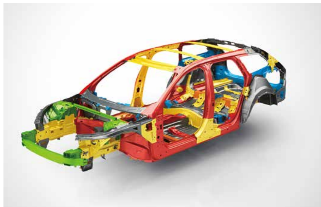
強度の異なる数種類のスチールを組み合わせた衝撃吸収システム構造 ■: MS (マイルドスチール) ■: HSS (ハイストレングススチール) ■: VHSS (ヘビーハイストレングススチール) ■: EHSS (エクストラハイストレングススチール) ■: UHSS (ウルトラハイストレングススチール/ポロンスチール) ■: アルミニウム
