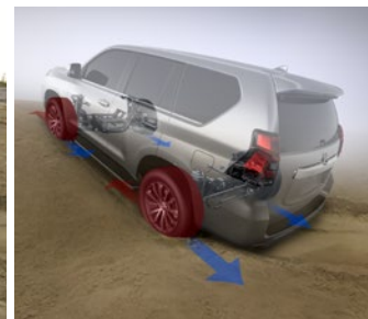
クロールコントロールシステム作動イメージ(スタック状態からの後退脱出)
