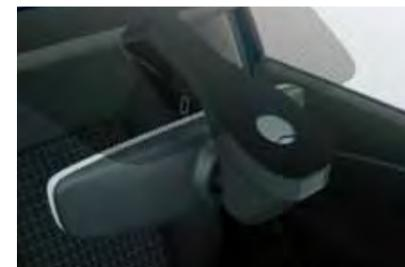
フロントウィンドー上部のセンサーで車外の明るさや雨を感知。“オート”を選択すれば、自動でヘッドライトを制御し、ワイパーの作動間隔を調整します。
