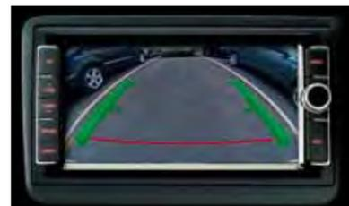
ギヤを“R”に入れると車両後方の映像を映し出します。映像にはガイドラインが示されるので、車庫入れや縦列駐車などが容易に行えます。
