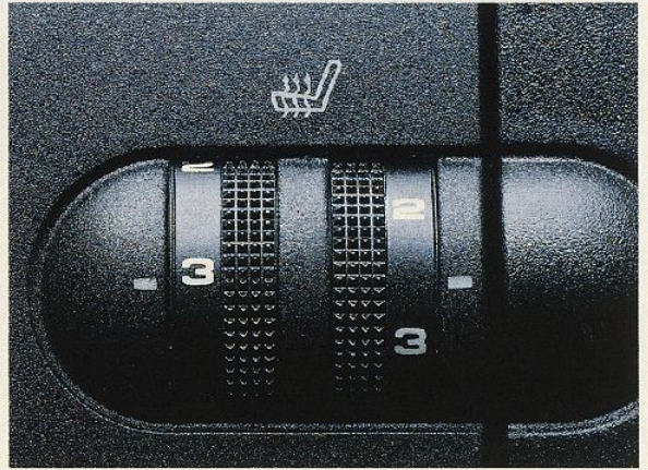
Die Sitzheizung. Sie spricht besonders schnell an, dadurch behagliches Sitzen, insbesondere bei Kaltstart im Winter. Temperatur kann für beide Vordersitze getrennt geregelt werden.
