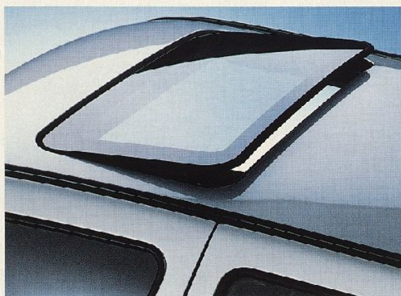
elektrisch betätigen. In Verbindung mit Zentralverriegelung läßt sich das elektrisch betätigte Schiebedach mit dem Zündschlüssel schließen.
