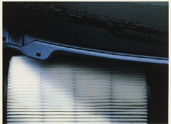
Der Staub- und Pollenfilter. Er reinigt die angesaugte Außenluft von Pollen- und Staubpartikeln und verbessert so die Luft im Fahrgeräum.
