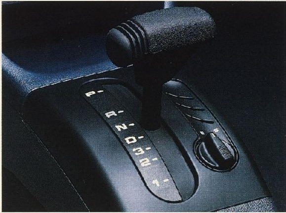
Die neue elektronisch/hydraulisch gesteuerte 4-Stufen-Automatic. Mit Wandlungsumgehung in der dritten (ab 50 km/h) und vierten Fahrstufe. Zwei Fahrprogramme (Sport/Economy). Bessere Beschleunigung und geringerer Kraftstoffverbrauch. Sicherung gegen unbeabsichtigtes Anfahren durch „Shift-LOCK“.
