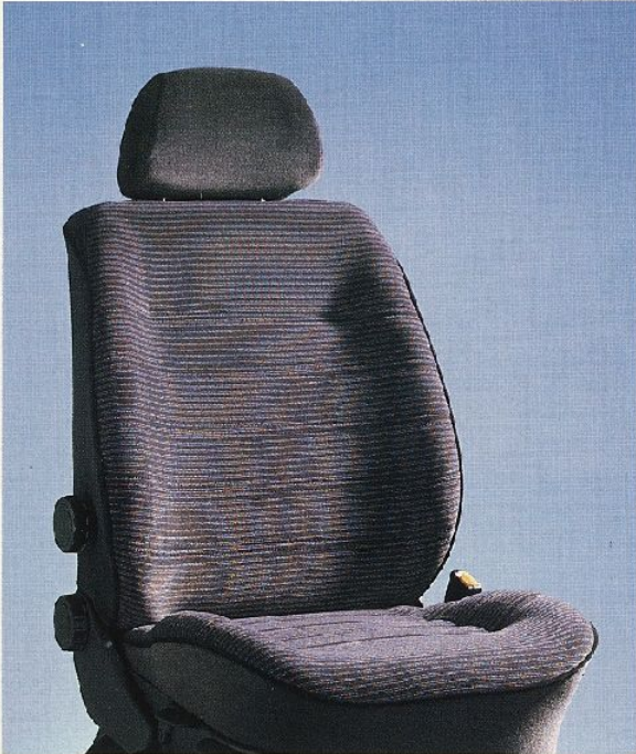
Der Komfortsitz mit zusätzlichen Einstellmöglichkeiten. Neben der Sitzlänge, Sitzhöhen- und Lehnenneigungseinstellung können bei diesem Sitz auch die Sitzfächernigung und Wirbelsäulenunterstützung eingestellt werden.
