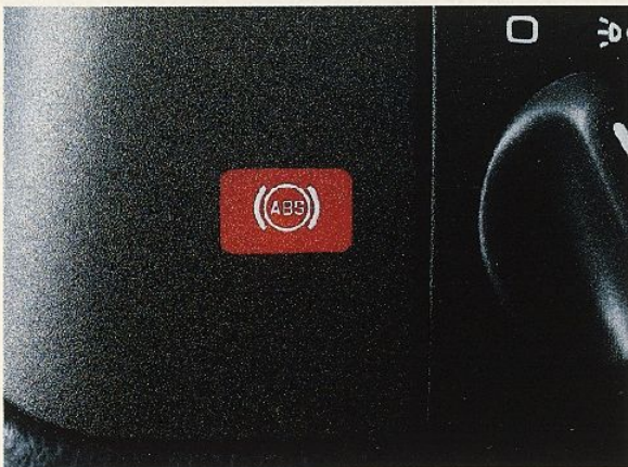
Das Anti-Blockier-System (ABS). Der Wagen bleibt auch bei Vollbremsung lenkfähig und unter Kontrolle, weil ein Microcomputer die Räder nicht blockieren lässt.
