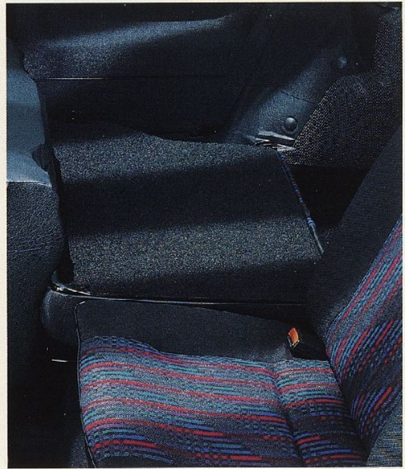
Die geteilt umklappbare Rücksitzbank und -lehne. Ganz umgeklappt läßt sich damit der Gepäckraumvolumen des neuen Golf von 330 Liter auf 1162 Liter Fassungsvermögen (nach VDA-Messung) erweitern. Dazu kann sie zu 1/2 bzw. 2/3 umgeklappt werden. Ganz individuell nach dem Platzbedarf dessen, was man zu transportieren hat.
