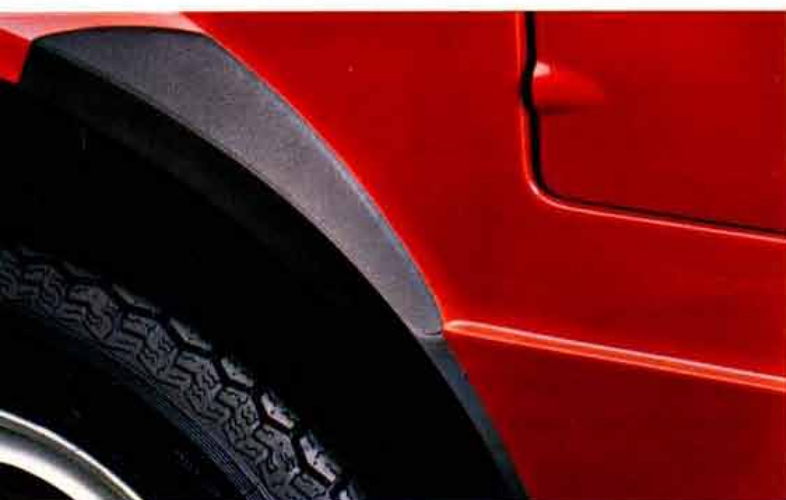
Modernster Korrosionsschutz rundherum und Steinschlagschutz an den hinteren Kotflügeln.
