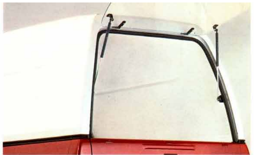
Der Komfort steckt im Detail: Das Betätigen der großen Heckklappe beim Kastenaufbau wird durch zwei Gasdruckfedern erleichtert.
