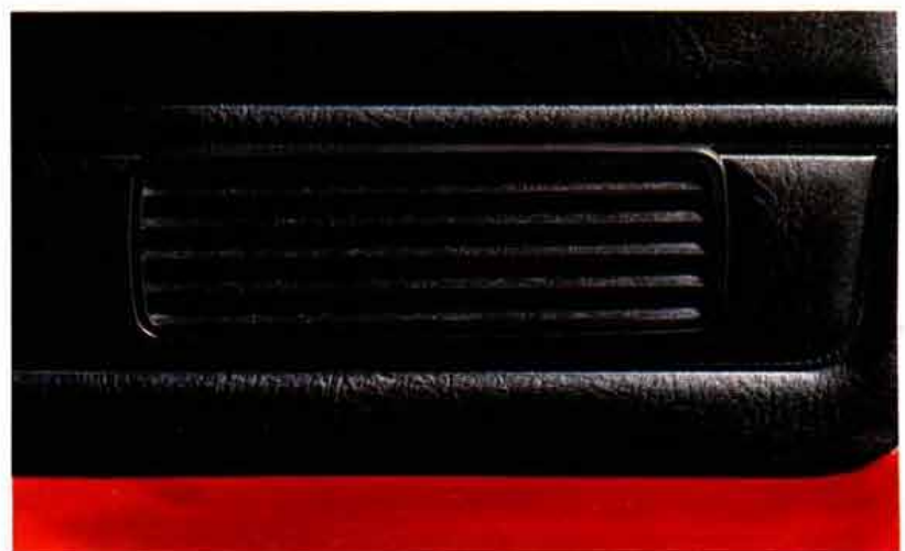
Frische Luft rein, verbrauchte Luft raus: Schlitze zur zugfreien Zwangsentlüftung sind in beiden Türen vorhanden.
