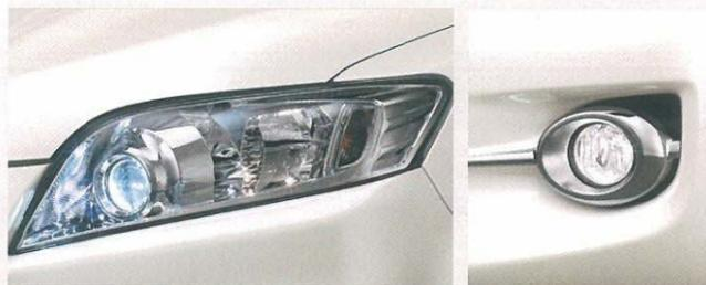
プロジェクター式ディスチャージヘッドランプ フロントフォグランプ
