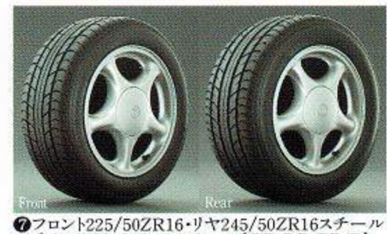
⑦ フロント225/50ZR16・リア245/50ZR16スチールラジアルタイヤ&アルミホイール (GZ, RZ, SZ-R) ※SZはフロント、リアとも225/50ZR16となります。 マグネシウムホイール (16インチ専用) (販売店装着オプション)
