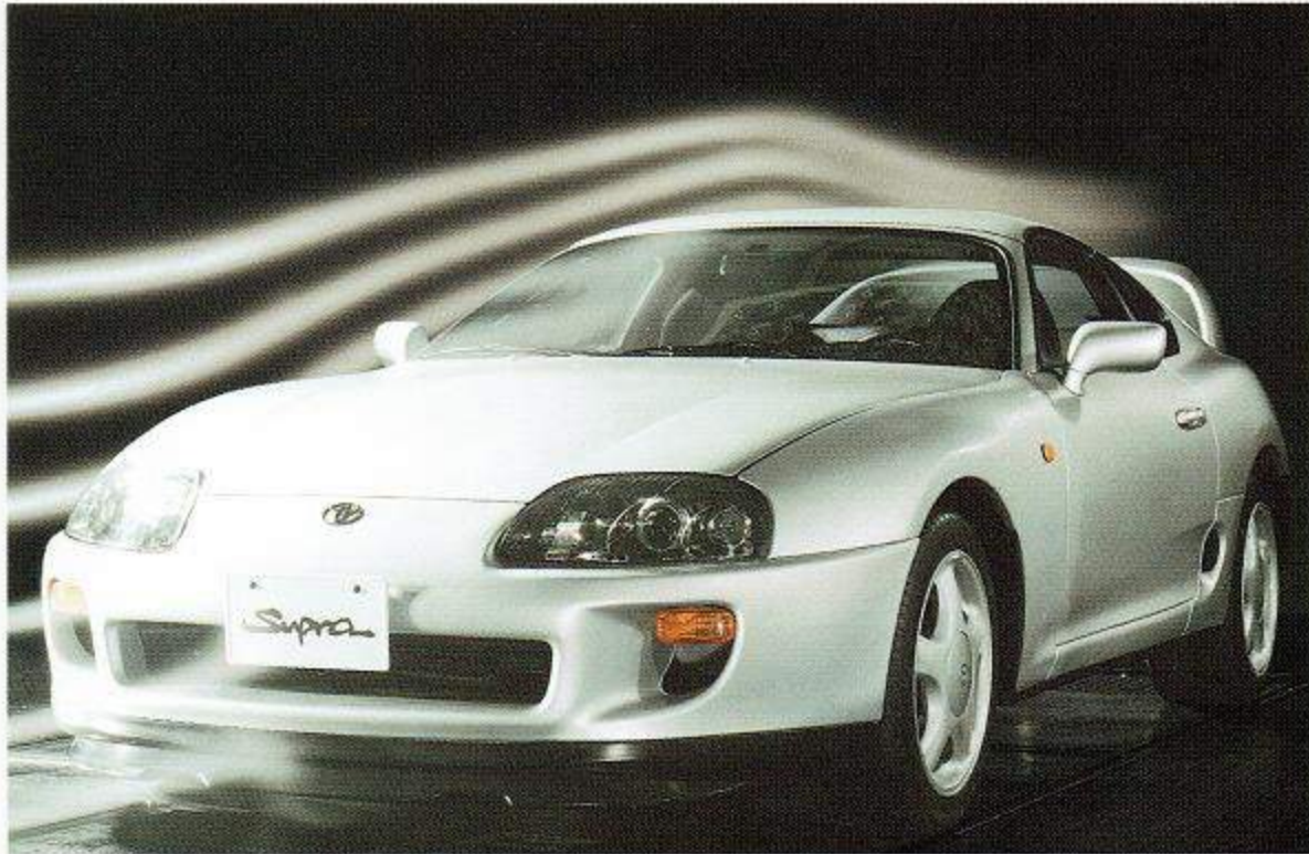
① 空力風洞実験フォト(写真は実験用の試作車です)
