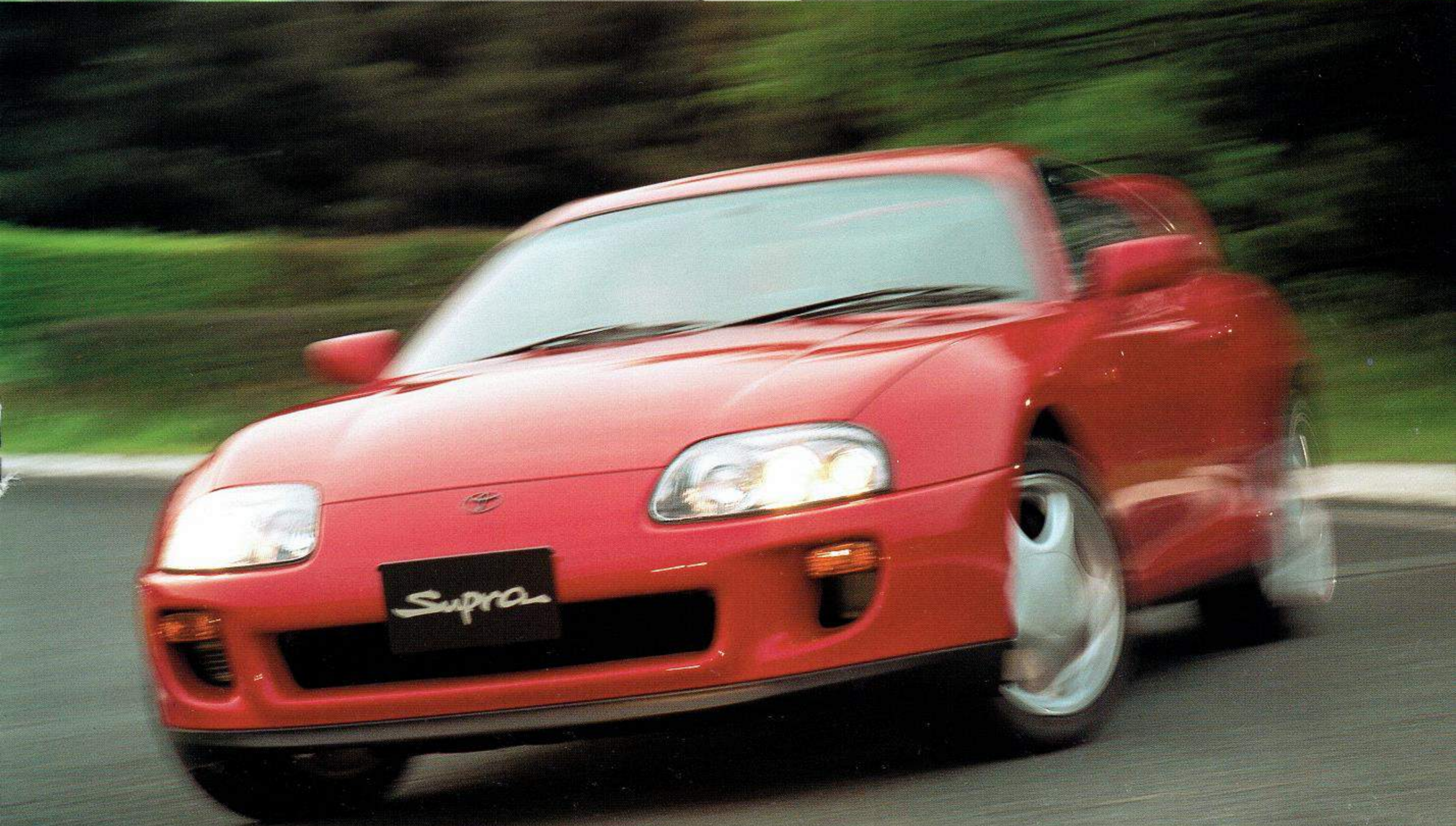
Photo:GZ ボデーカラーはスーパーレッドIV<3L2>。フロント235/45ZR17・リヤ255/40ZR17スチールラジアルタイヤ&アルミホイール+17インチ専用4輪ベンチレーテッドディスクブレーキ、大型リヤスポイラーはオプション
