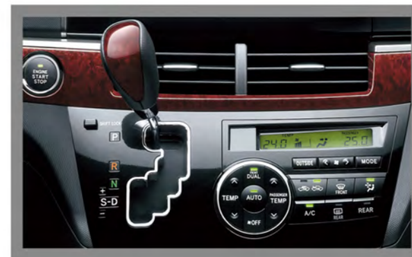
AI人工智慧六速手自排變速箱 (3.5L) 採用輕量化之六速人工智慧手自排變速箱，使引擎輸出更綿密 平順，同時擁有令人驚豔的加速表現；附斜坡邏輯控制系統。
