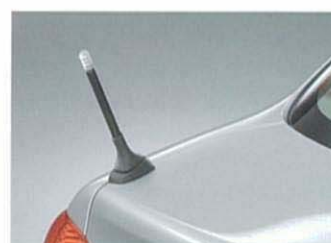
リヤフェンダーポール (夜間照明付)
