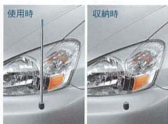
使用時 収納時 フェンダーランプ (電動リモコン伸縮式)
