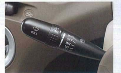
ウォッシャー連動時間調整式 間欠フロントワイパー (ミスト機構付)
