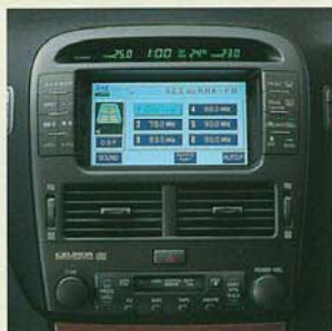
カセット—体AM/FMマルチ電子チューナーラジオ (DVDボイスナビゲーション付EMV装着車)
