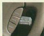
クルーズコントロールスイッチ/ マルチインフォメーションディスプレイ コントロールスイッチ
