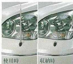
使用時 収納時 フェンダーランプ (電動リモコン伸縮式フロント)
