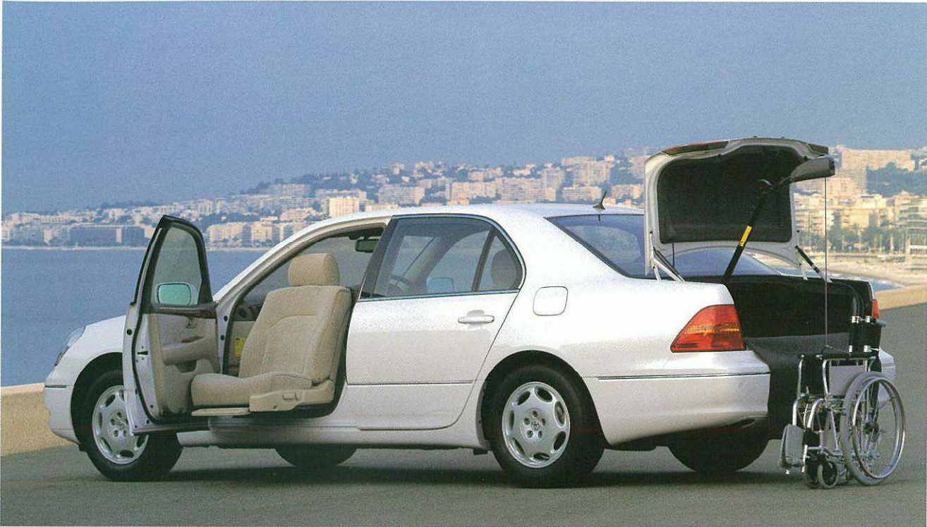
Photo:C仕様 全自動助手席回転スライドシート車“Bタイプ”(手動車いす用収納装置(電動式)付)(UA-UCF31-VRKFAQ<社内呼称>)。ボディカラーはホワイトパールクリスタルシャイン(062)。メーカーオプション装着車。車いすは架装メーカーオプション。
