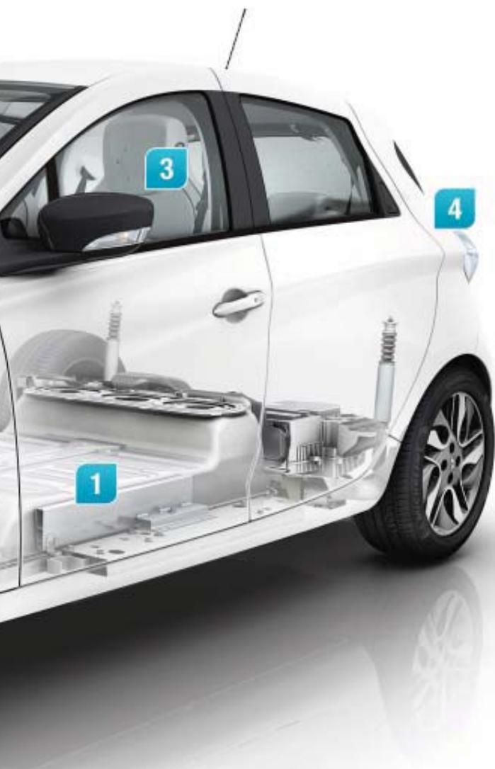
1. Batterie sous le plancher pour optimiser l'habitabilité et le volume de coffre. 2. Une surface vitrée pensée pour optimiser le style et l'autonomie. 3. 5 vraies places. 4. Volume de coffre de 338 l. 5. Freinage récupératif de nouvelle génération. 6. Pneus MICHELIN ENERGY™ E-V. 7. Pompe à chaleur. 8. Chargeur Caméléon™, 3 modes de charge possibles avec un seul et unique chargeur.
