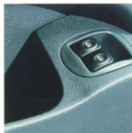
Bedieningsknoppen van de elektrisch bedienbare zijruiten voor en achter met veiligheidsmechanisme
