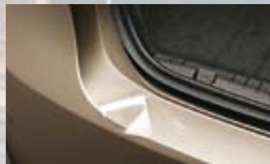
**Film de protection.** Mis en place sur le pare-chocs arrière, il protège contre les rayures lors du chargement/déchargement du véhicule et peut être retiré sans laisser de trace.
