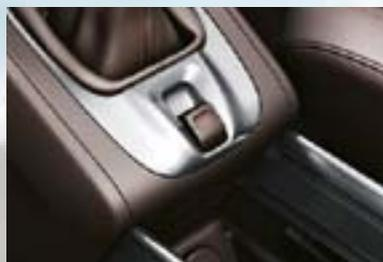
**Frein de stationnement électrique.** Confortable et pratique, il se serre automatiquement lorsque vous accélérez afin de faciliter les démarrages en côte.
