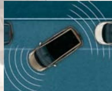
**Aide au stationnement.** Des capteurs à l'avant et à l'arrière émettent un avertissement sonore en cas de risque potentiel lors du stationnement. Le passage de la marche arrière active automatiquement cette fonction en cas de stationnement avant ou arrière.
