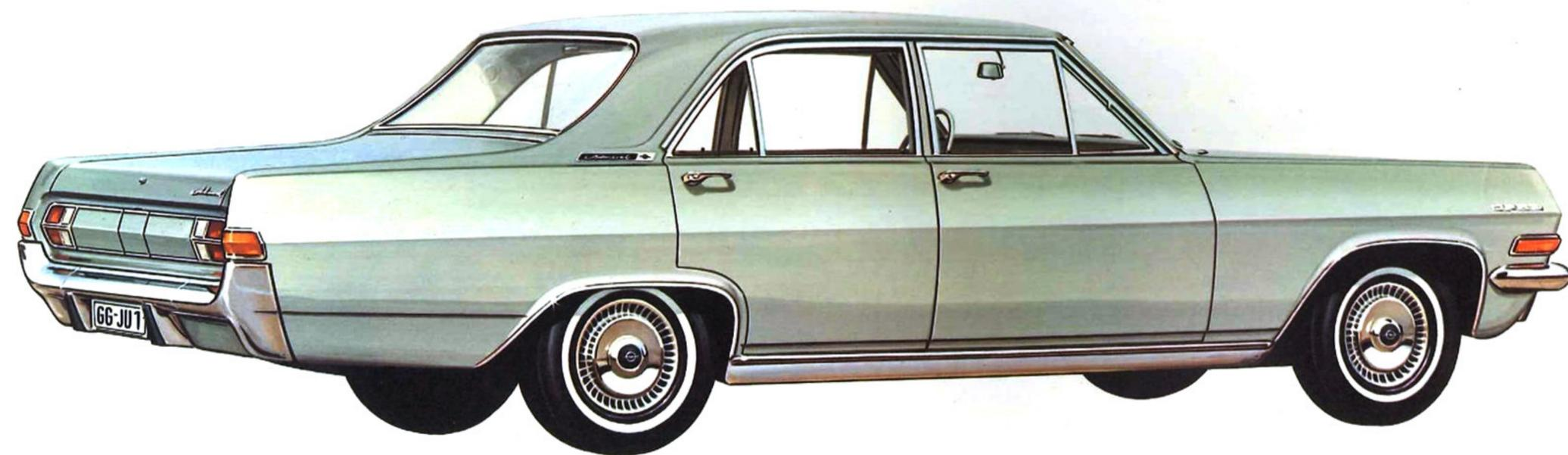
★ L'ADMIRAL n'a pas seulement un style très personnel, elle est aussi très robuste : les portes en sont à doubles parois et de nombreux caissonnages (au plancher, aux fenêtres, aux seuils des portes, etc...) renforcent sa structure générale.
