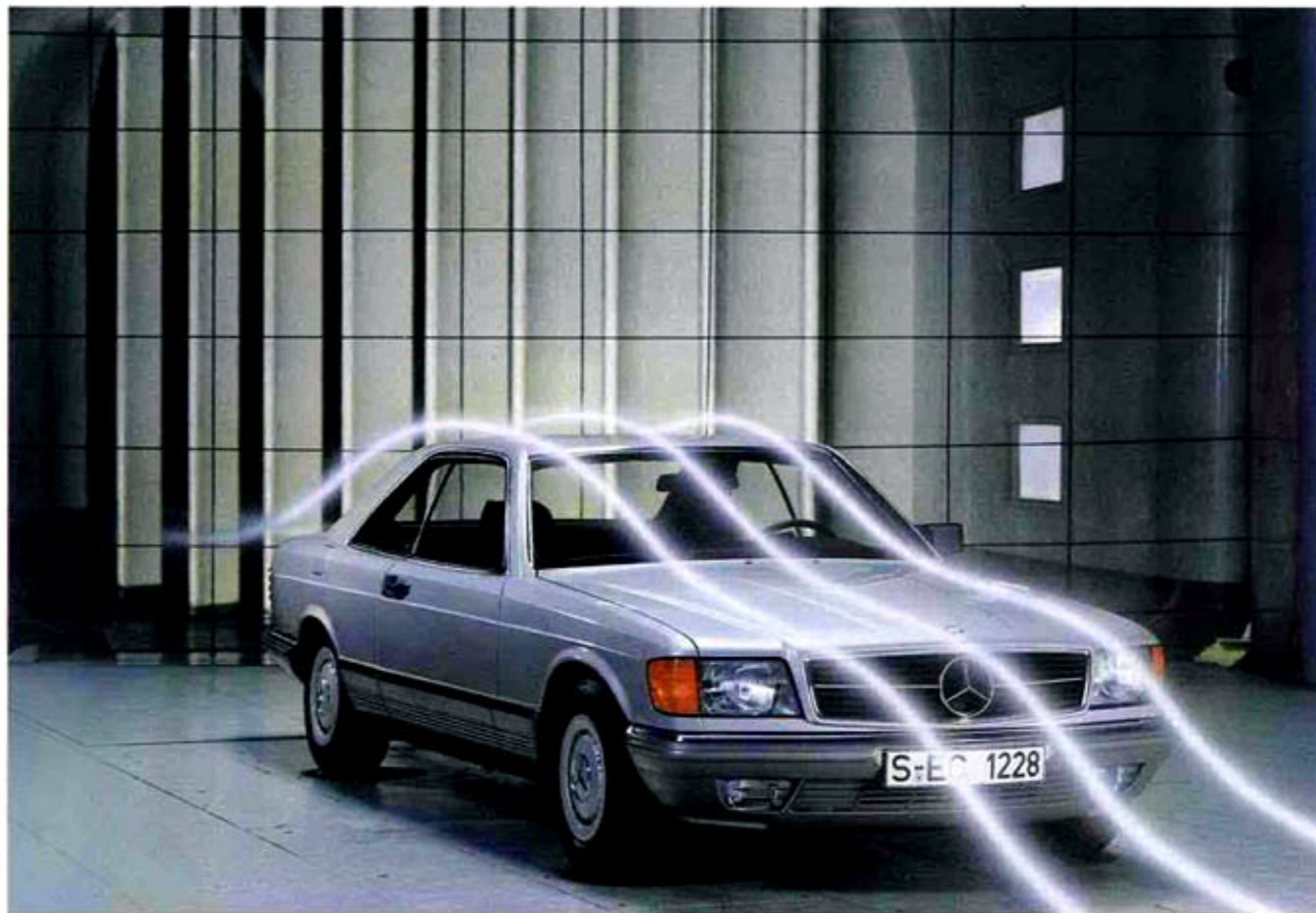
Resultat von Funktion und Form: der extrem niedrige Cw-Wert von 0,34.
