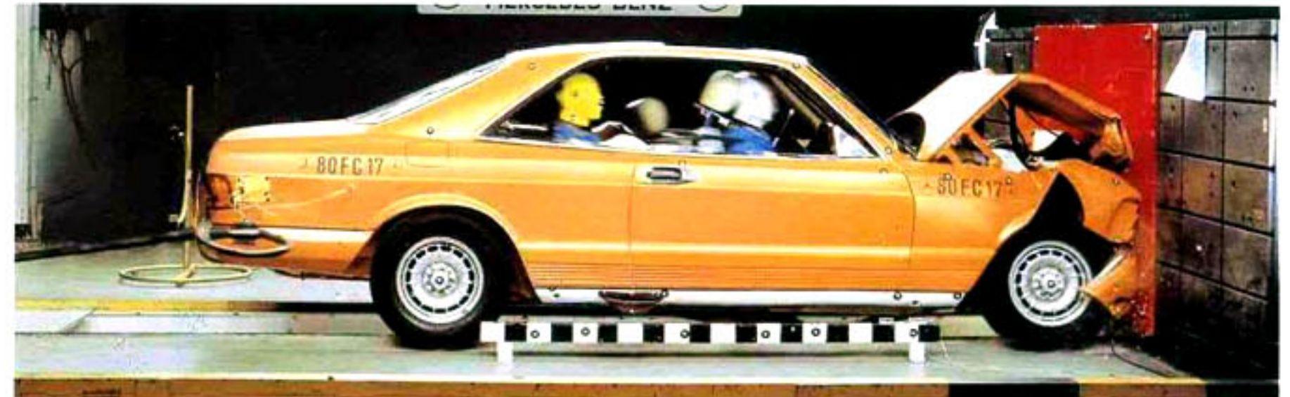
Die verlängerte Knautschzone mit gestaffelten Festigkeitszonen bietet bei Front- und Heckaufprall größtmögliche passive Sicherheit.
