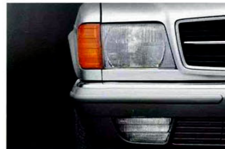
Integrierte Halogen-Leuchteinheit mit seitlich herumgezogenen Blinkleuchten und Nebellampen.
