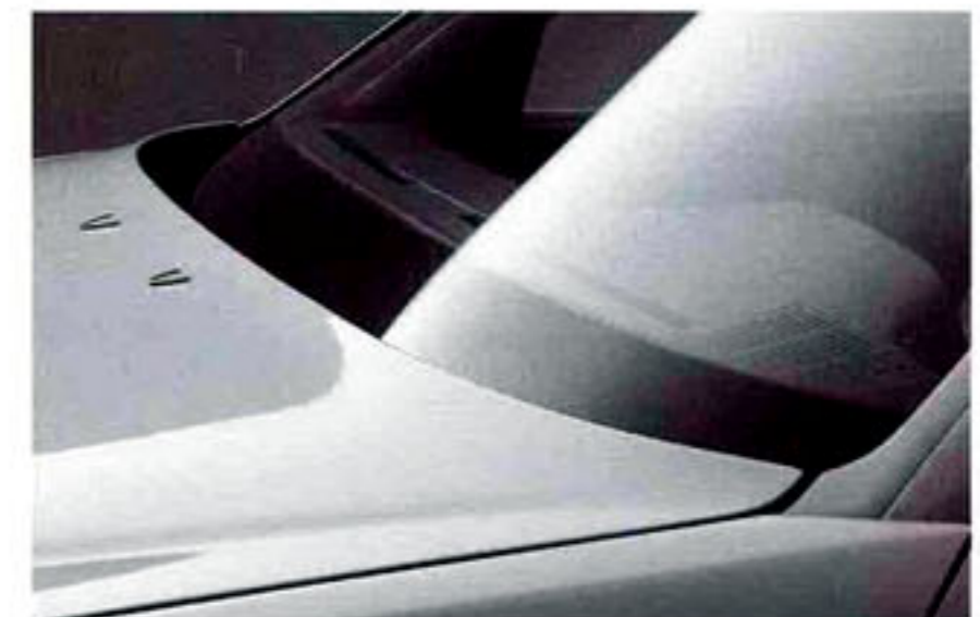
Versenkt angeordnete Scheibenwischer mit Überlastsicherung.
