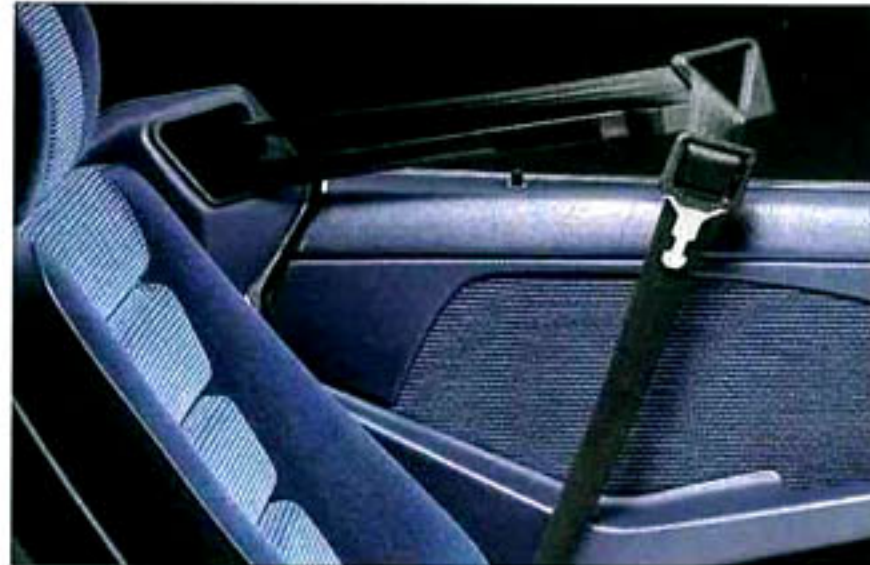
Gurtbringer führen automatisch die Gurte an Fahrer und Beifahrer heran.
