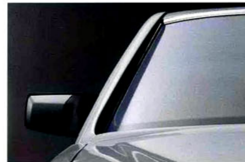
Vorderwandsäule mit versenkter Regenleiste und aerodynamisch gestaltetem, von innen verstellbarem Außenspiegel.
