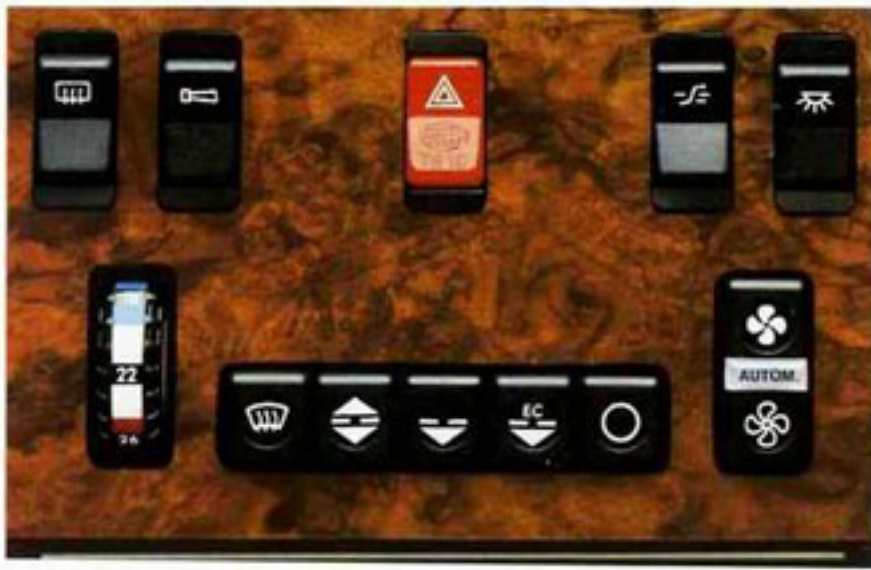
Die elektronisch gesteuerte Klimatisierungsautomatik hält die einmal vorgewählte Temperatur im Wageninneren konstant.
