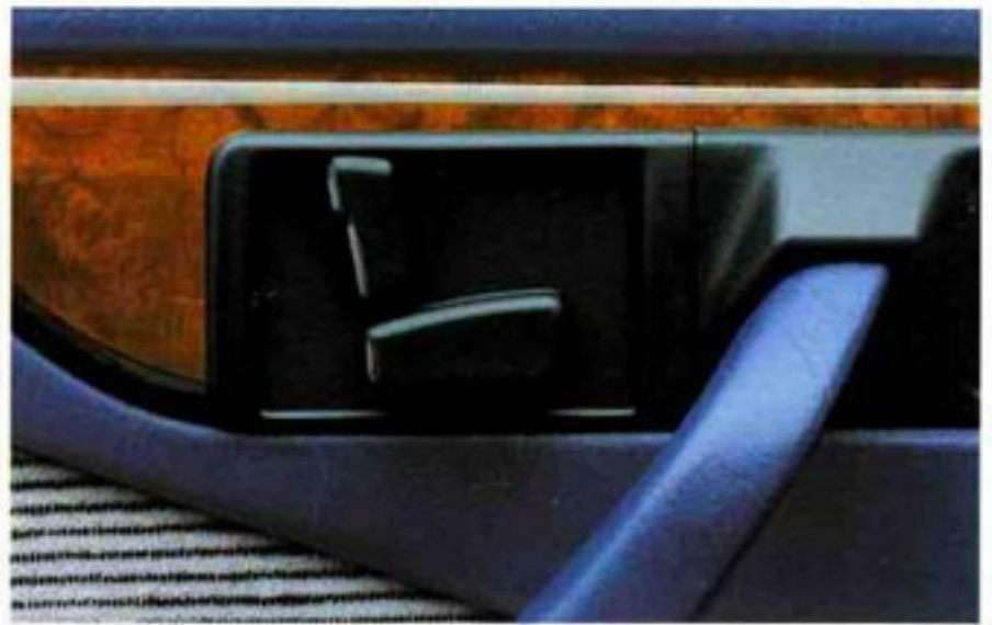
Mit diesem Symbolschalter können die Vordersitze achtfach elektrisch verstellt werden.
