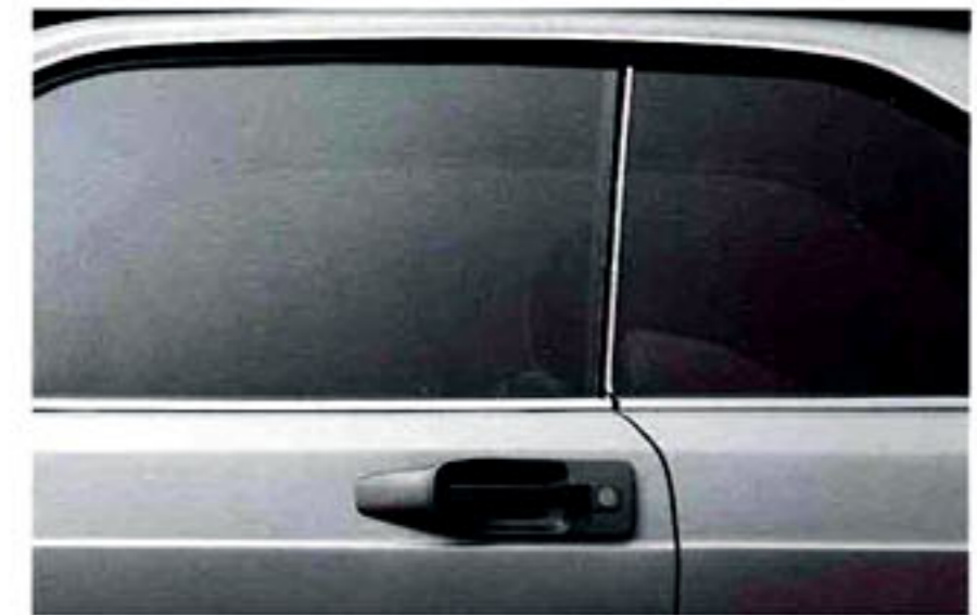
Türgriff mit Schutzblende und Wasserablaufloch im Schließzylinder.
