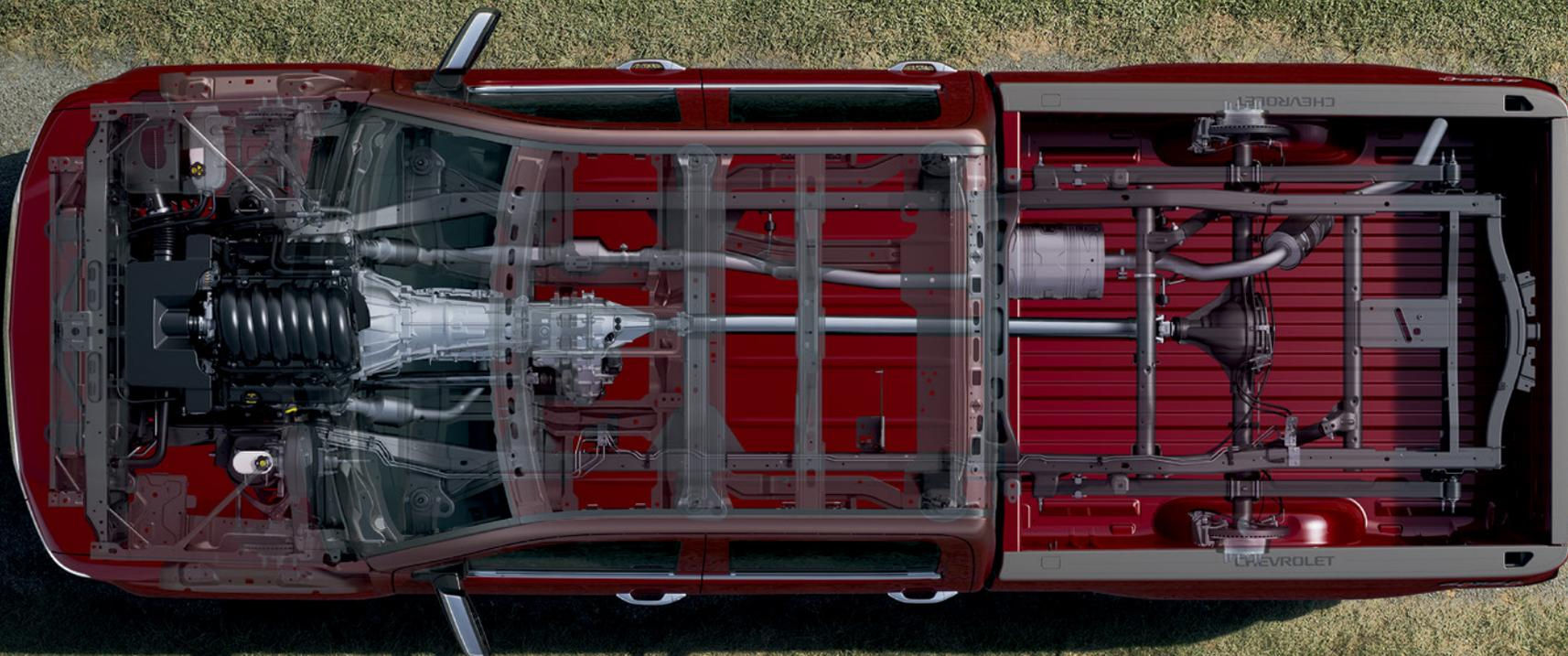
**ACIER À HAUTE RÉSISTANCE.** Le cadre du Silverado est ajusté avec précision pour mieux amortir les vibrations et assurer un comportement routier plus doux et une tenue de route sûre. Les montants, les longerons de toit et les bas de caisse sont fabriqués en acier à haute résistance pour mieux insonoriser la cabine.
