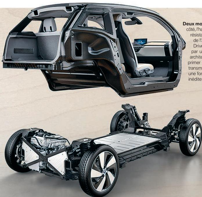
**Deux modules en parfaite interaction :** d'un côté, l'habitacle réalisé en fibre de carbone haute résistance extrêmement légère (module Life), de l'autre, le châssis en aluminium (module Drive). Les deux modules sont assemblés par un procédé tout à fait innovant. Cette architecture révolutionnaire permet de supprimer les montants centraux et le tunnel de transmission. La Nouvelle BMW i3 offre ainsi une formidable sensation d'espace tout à fait inédite dans une voiture de cette catégorie.
