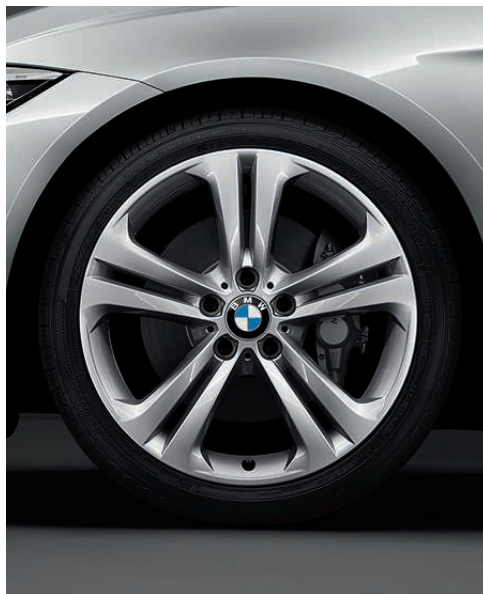
Jantes en alliage léger 19" (48 cm) style 401 à rayons doubles , avec monte pneumatique mixte RSC. Dimensions : 8 J x 19 à l'avant, pneumatiques 225/40 R 19 ; 8,5 J x 19 à l'arrière, pneumatiques 255/35 R 19.
