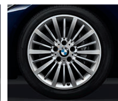
Jantes en alliage léger 18" (46 cm) style 416 à rayons multiples , polies, avec pneumatiques RSC. Dimensions : 8 J x 18, pneumatiques 225/45 R 18.
