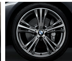
Jantes en alliage léger 19" (48 cm) style 407 à rayons en étoile , bicolores, avec monte pneumatique mixte RSC. Dimensions : 8 J x 19 à l'avant, pneumatiques 225/40 R 19 ; 8,5 J x 19 à l'arrière, pneumatiques 255/35 R 19.
