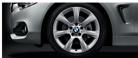
Jantes en alliage léger 18" (46 cm) style 396 à rayons en étoile , avec pneumatiques RSC. Dimensions : 8 J x 18, pneumatiques 225/45 R 18.
