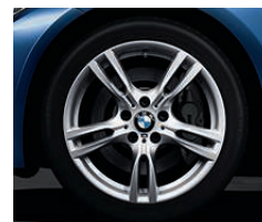
Jantes en alliage léger 18" (46 cm) style 400 M à rayons doubles , avec monte pneumatique mixte. Dimensions : 8 J x 18 à l'avant, pneumatiques 225/45 R 18 ; 8,5 J x 18 à l'arrière, pneumatiques 255/40 R 18. Freins Sport M! avec étriers fixes peints en bleu foncé, inscription « M » et disques de freins surdimensionnés pour une puissance de freinage plus importante.
