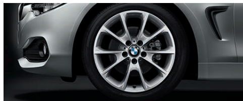
Jantes en alliage léger 18" (46 cm) style 398 à rayons en V , avec monte pneumatique mixte RSC. Dimensions : 8 J x 18 à l'avant, pneumatiques 225/45 R 18 ; 8,5 J x 18 à l'arrière, pneumatiques 255/40 R 18.
