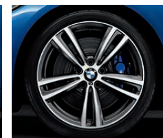
Jantes en alliage léger 19" (48 cm) style 442 M à rayons doubles « Ferricgrau » , bicolores et polies, avec monte pneumatique mixte. Dimensions : 8 J x 19 à l'avant, pneumatiques 225/40 R 19 ; 8,5 J x 19 à l'arrière, pneumatiques 255/35 R 19.
