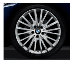
Jantes en alliage léger 19" (48 cm) style 399 à rayons multiples , avec monte pneumatique mixte RSC. Dimensions : 8 J x 19 à l'avant, pneumatiques 225/40 R 19 ; 8,5 J x 19 à l'arrière, pneumatiques 255/35 R 19.
