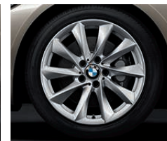
Jantes en alliage léger 18" (46 cm) style 415 turbine , avec pneumatiques RSC. Dimensions : 8 J x 18, pneumatiques 225/45 R 18.
