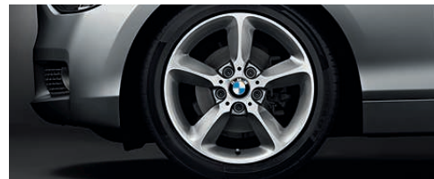
Jantes en alliage léger 17" (43 cm) style 382 1 à rayons en étoile, « Spacegrau » métallisé, bicolores et polies, avec monte pneumatique mixte. Dimensions : 7,5 J x 17 à l'avant, pneumatiques 225/45 R 17 ; 8 J x 17 à l'arrière, pneumatiques 245/40 R 17.
