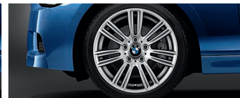
Jantes en alliage léger 17" (43 cm) style 383 M à rayons en étoile avec monte pneumatique mixte. Dimensions : 7,5 J x 17 à l'avant, pneumatiques 225/45 R 17 ; 8 J x 17 à l'arrière, pneumatiques 245/40 R 17 (uniquement en combinaison avec la Finition M Sport, disponible en option gratuite).
