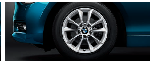
Jantes en alliage léger 16" (41 cm) style 411 à rayons en V. Dimensions : 7 J x 16, pneumatiques 205/55 R 16 (uniquement en combinaison avec la Finition UrbanLife, de série sur BMW 114i, 116i, 118i, 114d, 116d, 116d EfficientDynamics Edition, 118d et 120d).
