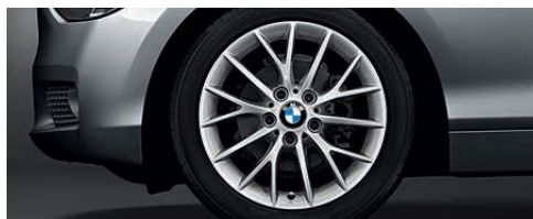
Jantes en alliage léger 17" (43 cm) style 380 1 à rayons en Y. Dimensions : 7 J x 17, pneumatiques 205/50 R 17 (de série sur BMW 125i et 125d).
