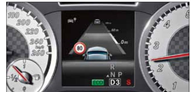
Die Anzeige des Geschwindigkeitslimit-Assistenten erfolgt sowohl im Kombiinstrument als auch im zentralen Display des COMAND Online.
