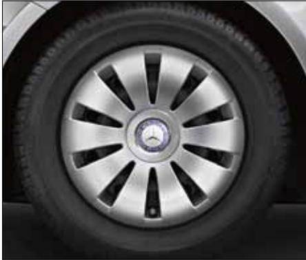
Stahlrad mit Radzierblende im 10-Loch-Design mit Bereifung 195/65 R 15 (Serie für A 160 CDI, A 180 CDI und A 180, Code R00).
