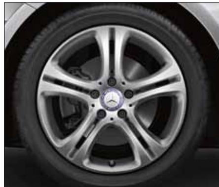
Leichtmetallrad im 5-Doppelspeichen-Design mit Bereifung 225/45 R 17 (Serie in Verbindung mit Urban, Code R11).
