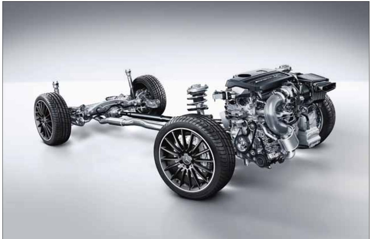
Eigenständige Achsschenkel vorne mit AMG spezifischer Elastokinematik erhöhen durch steifere Achslager die Dynamik.
