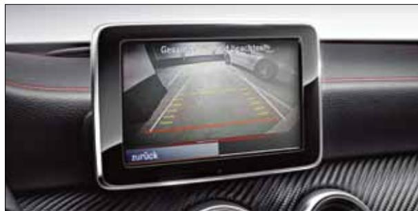
Das zentrale Display des COMAND Online zeigt den Bereich hinter dem Fahrzeug während des Einparkvorgangs.
