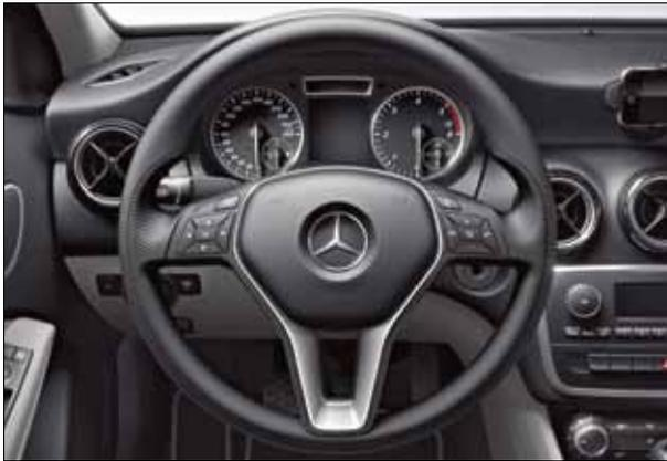
Multifunktionslenkrad im 3-Speichen-Design mit 12 Funktionstasten.
