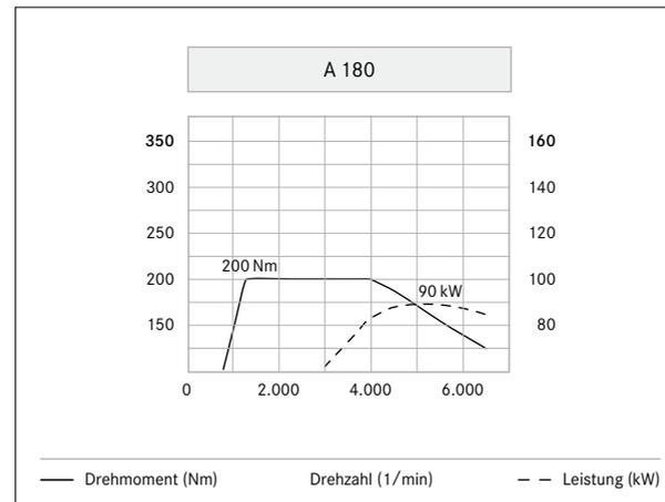
Der A 180 stellt ein maximales Drehmoment von 200 Nm im Bereich zwischen 1.250 und 4.000/min zur Verfügung.
