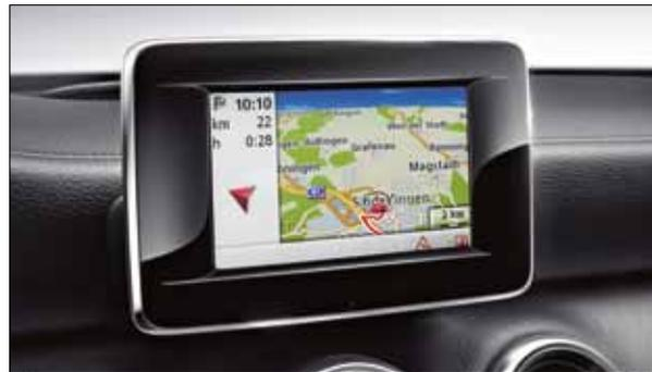
Die Anzeige des Becker® MAP PILOT erfolgt über das Display des Audio 20 CD sowie das Multifunktionsdisplay im Kombiinstrument.
