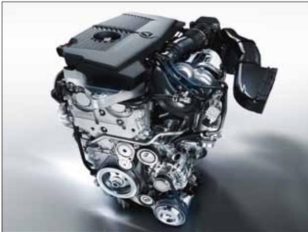
Der 4-Zylinder-Benzinmotor A 180 verfügt über Direkteinspritzung mittels Piezo-Injektoren und Turboaufladung.
