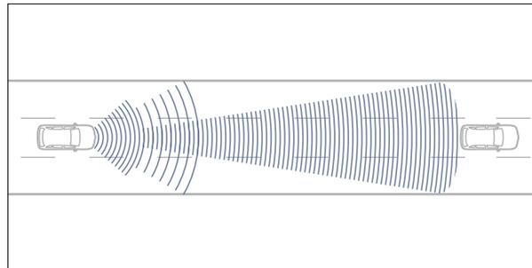
Der Abstandsregeltempomat DISTRONIC PLUS unterstützt den Fahrer dabei, sein Fahrzeug automatisch auf Abstand zu einem vorausfahrenden Fahrzeug zu halten.
