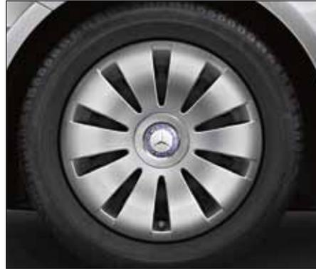
Stahlrad mit Radzierblende im 10-Loch-Design mit Bereifung 205/55 R 16 (Serie für A 200 CDI und A 200, Code 643).
