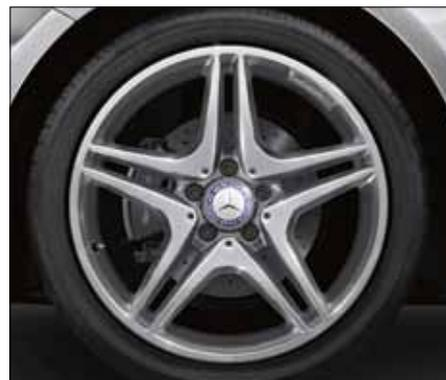
AMG Leichtmetallrad im 5-Doppelspeichen-Design, titangrau lackiert, glanzgedreht, mit Bereifung 225/40 R 18 (Option, Code 794).
