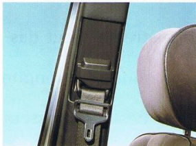
Die Gurthöhen-Verstellung an den Vordersitzen ist sitzgerecht in die Gestaltung der Mittelsäule integriert.
