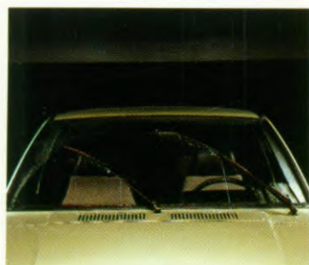
Betrouwbare ruitwissers met 2 snelheden. GL en GS uitvoering hebben bovendien een interval schakelaar.
