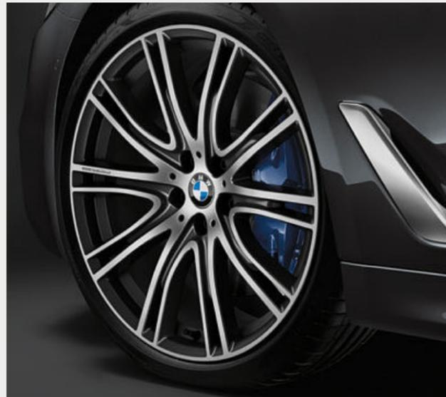
□ Llantas de aleación ligera BMW Individual de 20 pulgadas con radios en V estilo 759 I, bicolor, delante 8J x 20, neumáticos 245/35 R 20, detrás 9J x 20, neumáticos 275/30 R 20.
