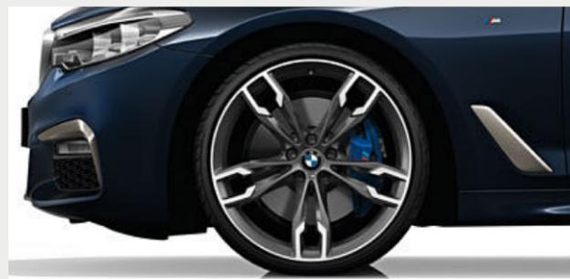
○ Llantas de aleación ligera M de 20 pulgadas con radios dobles estilo 668 M, Ceriumgrau<sup>2</sup> mate de brillo intenso, con neumáticos deportivos de distintas medidas, delante 8J x 20, neumáticos 245/35 R 20, detrás 9J x 20, neumáticos 275/30 R 20.
