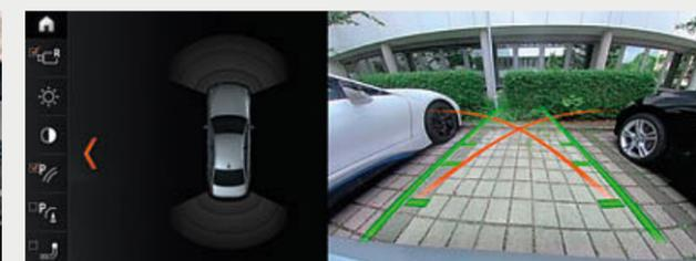
□ La cámara para marcha atrás ofrece una mejor orientación al circular hacia atrás en las maniobras de aparcamiento y a velocidades inferiores a 15 km/h. Muestra en el display de control la zona situada detrás del vehículo. Unas marcas de carril interactivas que indican la distancia y el radio de giro apoyan al conductor en las maniobras, y los obstáculos se indican en color.
