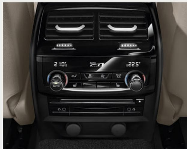
□ El climatizador de 4 zonas dispone del equipamiento del climatizador bi-zona con funciones ampliadas y de dos salidas de aire adicionales en los pilares centrales. Además, la temperatura de la parte trasera se puede regular individualmente por medio de un mando independiente con indicador.
