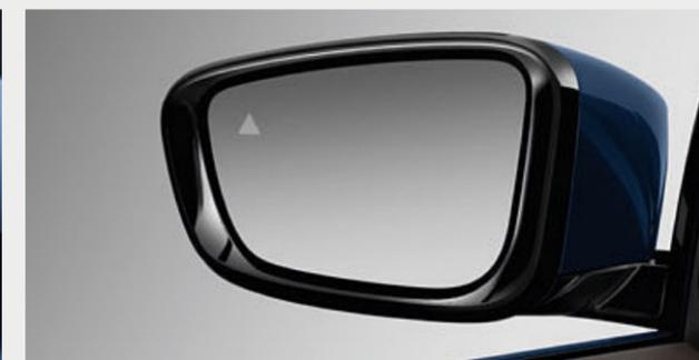
□ La advertencia de cambio de carril avisa<sup>2</sup>, con los intermitentes activados, de la presencia de un vehículo en el ángulo muerto o de la aproximación de un vehículo por el carril adyacente. El sistema actúa a partir de una velocidad de 20 km/h, hace vibrar el volante en situaciones de peligro y muestra un símbolo en forma de triángulo intermitente en el retrovisor exterior.
