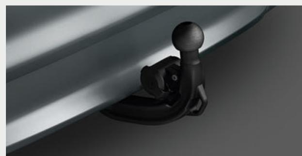
□ El enganche de remolque con bola giratoria eléctrica, admite cargas de hasta 2.000 kg. Para lograr la estabilización, el control de estabilidad del remolque frena de forma automática si se produce una oscilación del remolque. Plegado debajo del faldón trasero, no se ve la bola giratoria eléctrica.
