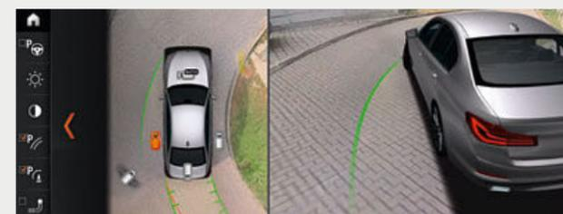
□ El paquete de equipamiento Parking Assistant facilita el aparcamiento y las maniobras del vehículo. Incluye Surround View con Top View, Remote 3D View, PDC con guiado longitudinal, que estaciona el vehículo de forma totalmente automática en paralelo a la calzada y en batería. Para ello, el sistema mide las plazas de aparcamiento al pasar por delante a baja velocidad.
