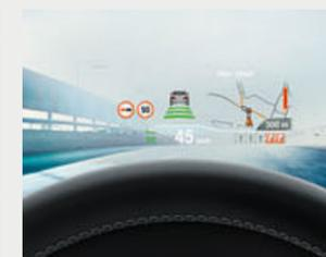
□ El BMW Head-Up Display<sup>3</sup> a todo color proyecta la información relevante para la conducción en el campo visual del conductor.
