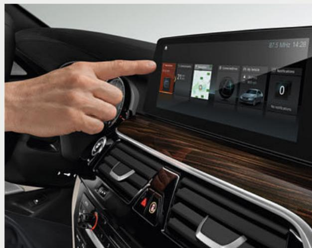
□ Con el Control de gestos BMW, se pueden manejar determinadas funciones con movimientos concretos de las manos. Para determinadas operaciones, el sistema reconoce, por ejemplo, los gestos “deslizar” y “señalar”, con los cuales es posible rechazar o aceptar un llamada de teléfono, o el movimiento de giro con el dedo índice para regular el volumen.
