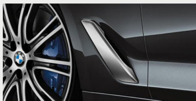
■ El sistema Air Breather canaliza el aire en la zona de las ruedas delanteras, reduce la resistencia aerodinámica, el consumo y las emisiones de CO<sub>2</sub>.
