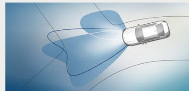
□ Los faros **LED con luces autoadaptables**, regulación variable del alcance en ciudad y carretera y BMW Selective Beam (asistente de luz de carretera antideslumbramiento), garantizan una iluminación óptima. Incluso con el vehículo parado, la luz de giro integrada se activa automáticamente al accionar el intermitente o al girar el volante, y se mantiene activa hasta alcanzar una velocidad de 35 km/h.
