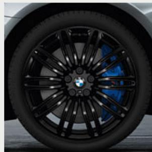
□ Llantas de aleación ligera M de 19 pulgadas con radios dobles estilo 664 M jet black sólido<sup>1</sup>, con neumáticos de distintas medidas y funcionamiento en caso de avería, delante 8J x 19, neumáticos 245/40 R 19, detrás 9J x 19, neumáticos 275/35 R 19.
