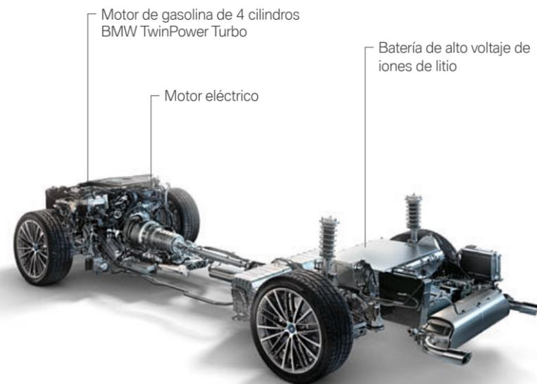
Motor de gasolina de 4 cilindros BMW TwinPower Turbo
