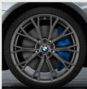
○ Llantas de aleación ligera BMW M Performance de 20 pulgadas, radios dobles estilo 669M, bicolor, Schwarz mate, pulido brillante, neumáticos de distintas medidas, funcionamiento en avería, delante 8J x 20, neumáticos 245/35 R 20, detrás 9J x 20, neumáticos 275/30 R 20.
