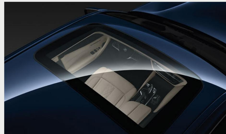
□ El techo de cristal corredizo y abatible, con cortinilla interior corrediza eléctricamente, dispositivo de protección antiaprisionamiento y apertura y cierre de confort, permite la regulación individual del flujo del aire y, con ello, un clima agradable en el interior. El deflector integrado evita las corrientes de aire en el interior y garantiza el mínimo ruido del viento.
