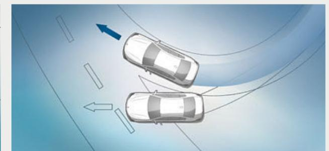
■ El **Control Dinámico de Estabilidad (DSC)** detecta continuamente el estado de la marcha y estabiliza el vehículo a través de la gestión del motor y los frenos en caso de inestabilidad del vehículo. Otras funciones del DSC son, por ejemplo, el secado de los frenos, la preparación de los frenos o el asistente de arranque, que mantiene el vehículo brevemente en su sitio cuando se arranca en pendiente, evitando así que retroceda.
