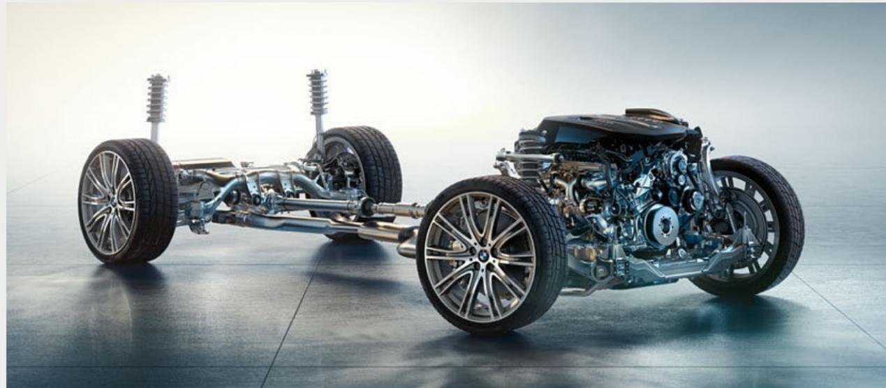
La **dirección activa integral**<sup>1</sup> combina una desmultiplicación variable en el eje delantero con ruedas traseras direccionables. Gracias al viraje de las ruedas traseras en sentido contrario a la dirección, ofrece un extra de maniobrabilidad y agilidad a baja velocidad. A partir de aproximadamente 60 km/h, las ruedas traseras giran en la misma dirección para incrementar la estabilidad y el confort.
