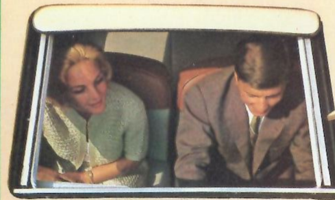
Das vollkommen dichte Stahlschiebedach kann während der Fahrt leicht betätigt werden.
