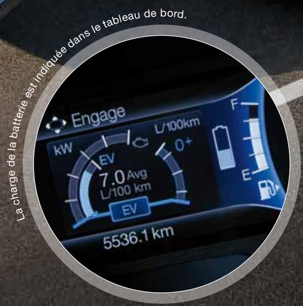
La charge de la batterie est indiquée dans le tableau de bord.
