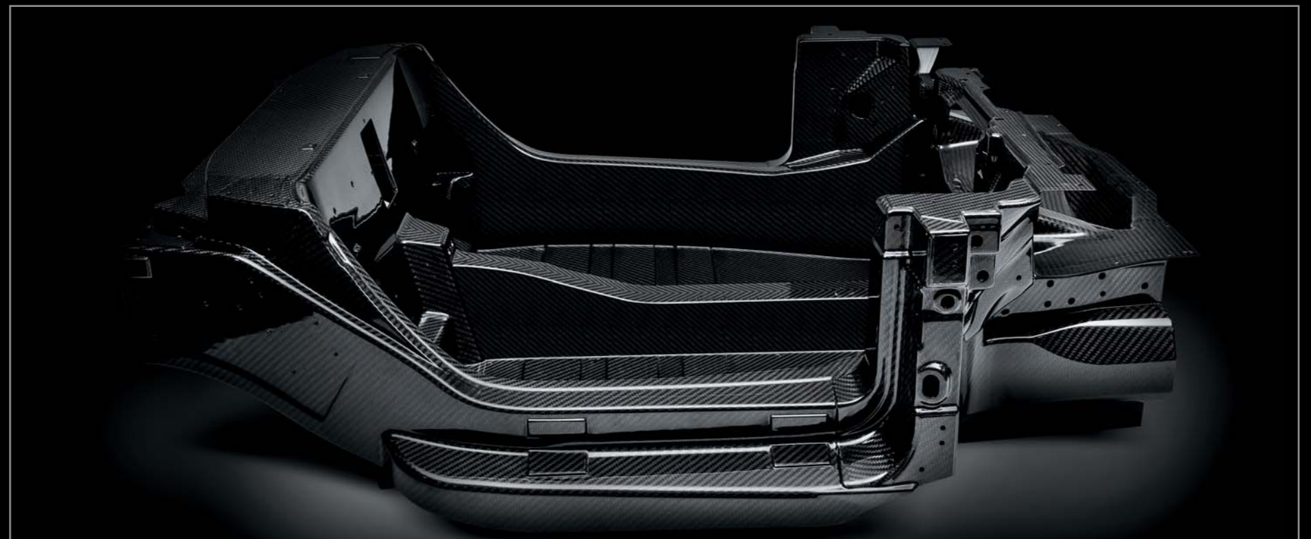
Monocoque aus Kohlefaser
