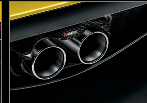
Zentraler Titan-Auspuff mit Akrapovič Dual-Mode Funktion
