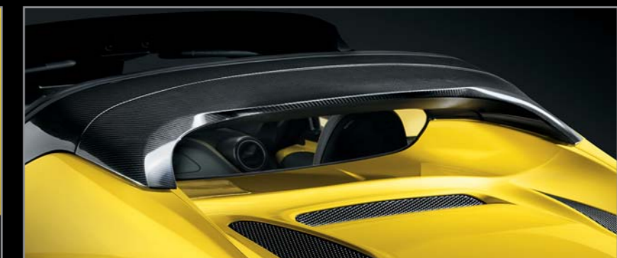
Überrollbügelverkleidung aus Kohlefaser
