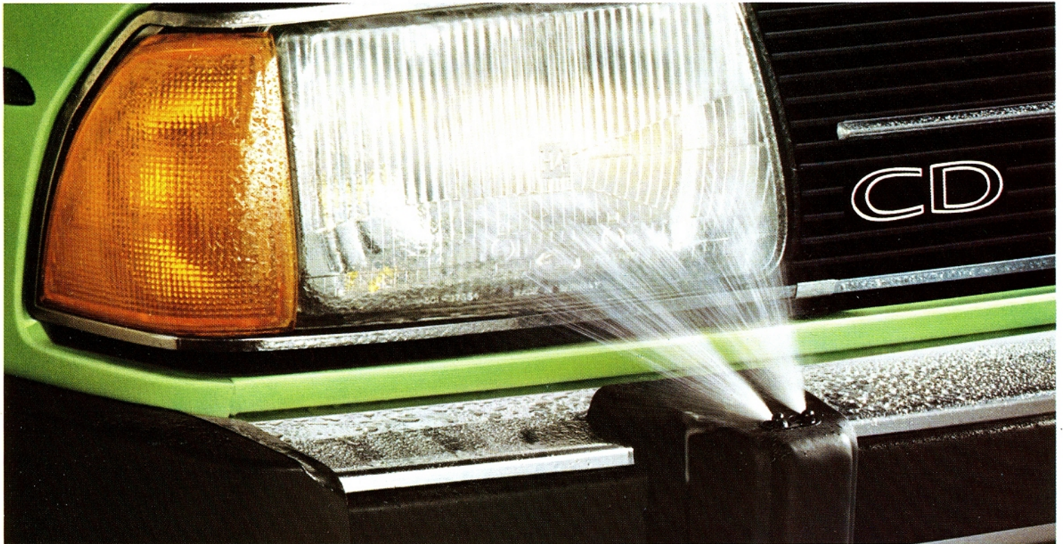
Die Scheinwerfer-Reinigungsanlage für sichere Sicht.
