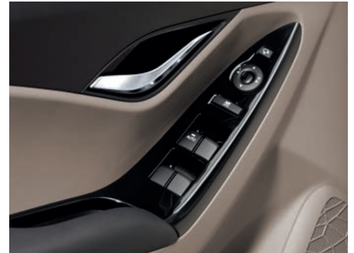
El reposabrazos de la puerta, con elevallas eléctricas (delanteros y traseros) y botones de control para los retrovisores exteriores eléctricos en todas las versiones.
