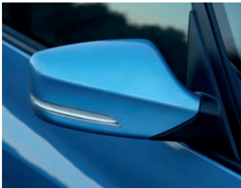
Retrovisor exterior del color de la carrocería, eléctrico, calefactable y con intermitente integrado.
