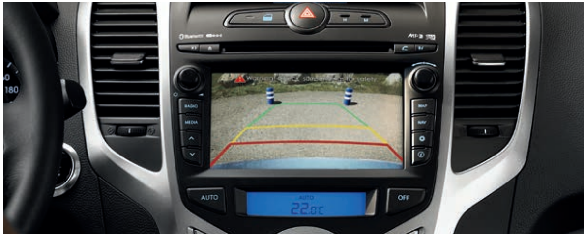
Cámara de aparcamiento trasero. El navegador del ix20 ofrece la función adicional de cámara al engranar la marcha atrás. La cámara dispone de unas guías superpuestas que orientan sobre la cercanía de los objetos detrás de su ix20.
