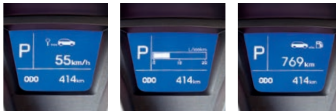
Ordenador de a bordo. El ordenador de a bordo muestra datos esenciales del viaje en forma de texto o iconos: velocidad media, tiempo de conducción, autonomía, distancia recorrida del viaje A y del viaje B, así como consumo de combustible instantáneo y promedio. Éstas son algunas de las distintas funciones a las que puede acceder mediante los mandos a distancia del volante.
