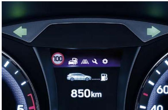
**Spurhalteassistent und Verkehrszeichenassistent.** Durch automatisches Gegenlenken verhindert der Spurhalteassistent das unbeabsichtigte Verlassen der Fahrspur. Der Verkehrszeichenassistent macht auf Geschwindigkeitsbegrenzungen und Überholverbote aufmerksam.
