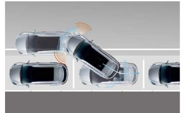
**Automatischer Einparkassistent (SPAS).** Die aktivierten Sensoren können einen passenden Parkplatz erkennen und den neuen Hyundai i40 perfekt hineinmanövrieren. Sie bedienen lediglich Gas und Bremse, der Assistent macht den Rest.
