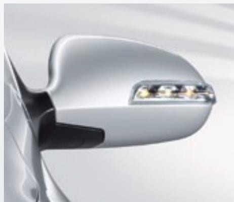
Den Außenspiegel gibt es ab Ausstattungslinie Comfort in Wagenfarbe lackiert, beheizbar, elektrisch anklapp- und einstellbar sowie mit integriertem Blinker.
