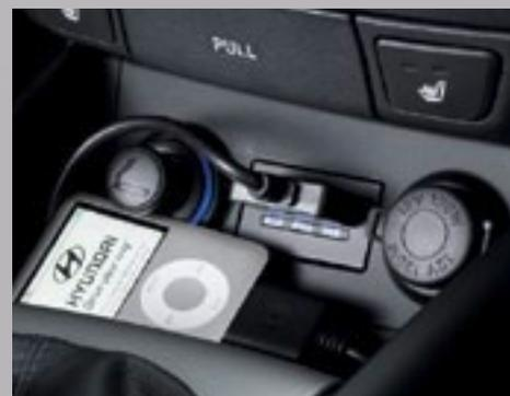
Im unteren Bereich der Mittelkonsole – und damit für Fahrer und Beifahrer gleichermaßen gut erreichbar – befinden sich 12-V-Steckdose, USB- und AUX-Anschlüsse.
