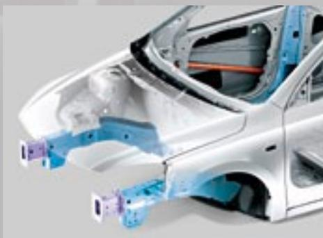
Im Fall eines Frontalzusammenstoßes wird die Aufprallenergie durch spezielle Dämpfer absorbiert und somit die Fahrgastzelle zusätzlich geschützt.
