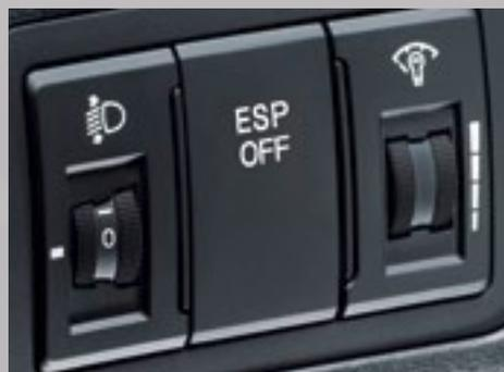
Das serienmäßige ESP zum automatischen Abbremsen der Räder in zu schnell gefahrenen Kurven ist auf Wunsch auch abschaltbar. Ein Knopfdruck genügt.
