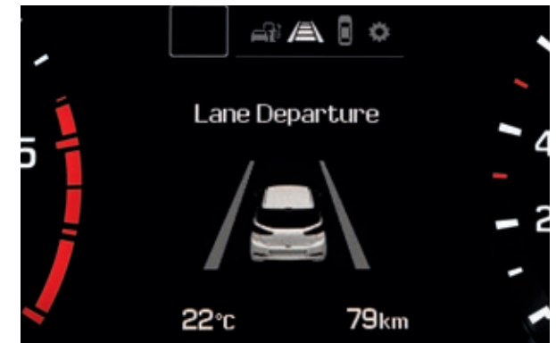
Vognbaneassistent. Øjeblikkelig akustisk og visuel advarsel, hvis du utilsigtet forlader den vognbane, du kører i. Afhængig af variant.
