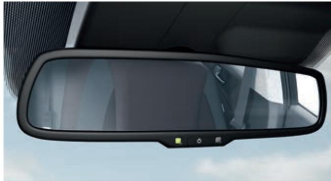
**Espejo electro-cromático (electro-chromatic mirror, ECM).** El retrovisor interior se oscurece automáticamente cuando su sensor detecta el brillo de los coches que vienen detrás.
