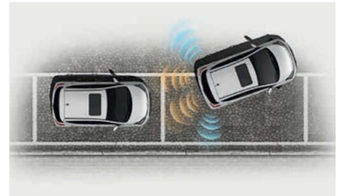
**Sensor de parking trasero.** Estos discretos sensores detectan los posibles obstáculos durante las maniobras de estacionamiento y avisan con una señal acústica.
