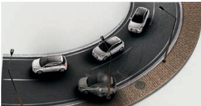
**Control electrónico de estabilidad.** Funciona conjuntamente con la gestión de estabilidad del vehículo (Vehicle Stability Management) para mantener el agarre y el control, especialmente en superficies con poca tracción.
