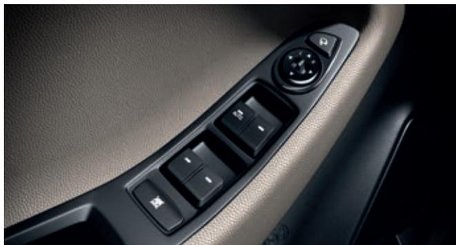
**Elevalunas eléctricos delanteros y traseros.** Las lunas laterales se suben y bajan tocando un botón. Las lunas delanteras tienen subida y bajada automática con un toque.
