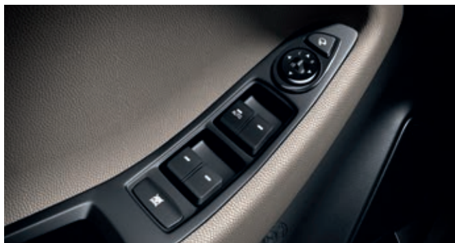
Elevalunas eléctricos delanteros y traseros. Las lunas laterales se elevan y bajan tocando un botón. Las lunas delanteras tienen subida y bajada automática con un toque.
