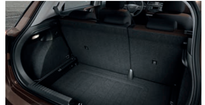
Suelo de maletero ajustable en altura. El suelo del maletero se puede colocar a dos alturas, para crear una superficie continua cuando se abaten los asientos traseros, o un espacio de carga más profundo, si así se desea.
