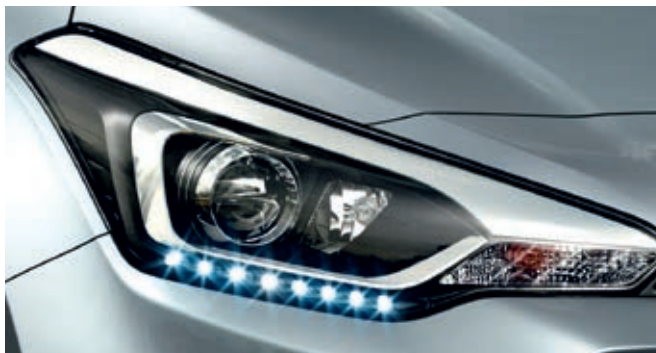
Faros proyectores de alto rendimiento. Luces de alcance lateral y doble tecnología LED tanto en luces diurnas como de posición.
