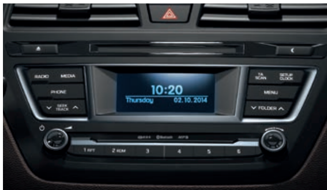
Sistema de sonido. Radio RDS con reproductor de CD/MP3 y conectividad Bluetooth. El sistema también se puede controlar con el volante multifunción.
