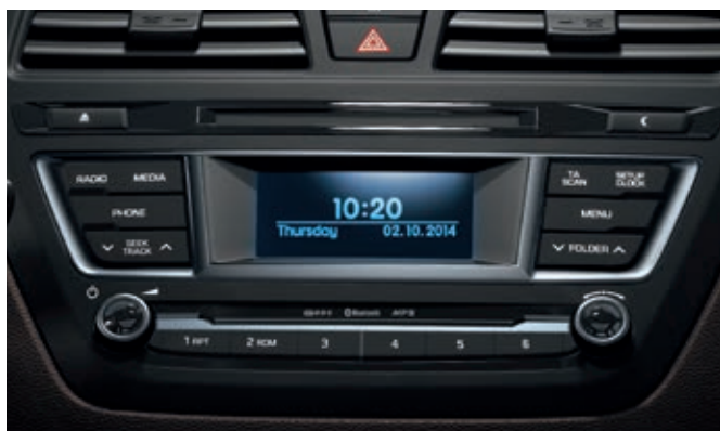
Sistema de sonido. Radio RDS con reproductor de CD/MP3 y conectividad Bluetooth. El sistema también se puede controlar con el volante multifunción.
