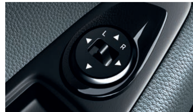
Espejos retrovisores eléctricos calefactables con intermitentes de LED integrados. Los retrovisores exteriores se pueden ajustar y calentar desde la consola de la puerta.
