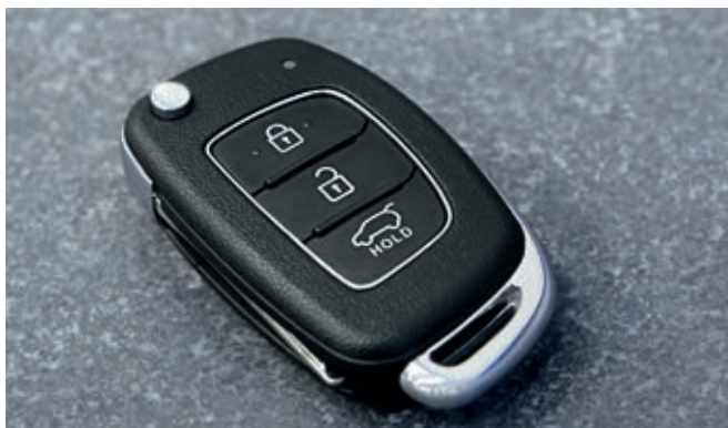
Cierre centralizado remoto con alarma. Las puertas y el portón trasero pueden ser abiertos o cerrados con los botones de la llave.
