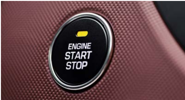
Smart-Key-System mit Start-/Stop-Knopf 2 . Sie können den Motor ohne Schlüssel starten, wenn Sie den Smart Key in Ihrer Hand- oder Hosentasche bei sich haben.
