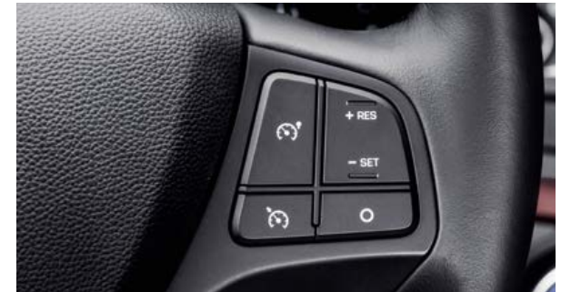
Geschwindigkeitsregelanlage mit Geschwindigkeitsbegrenzer 1 . Für stressfreies Fahren auf längeren Reisen.
