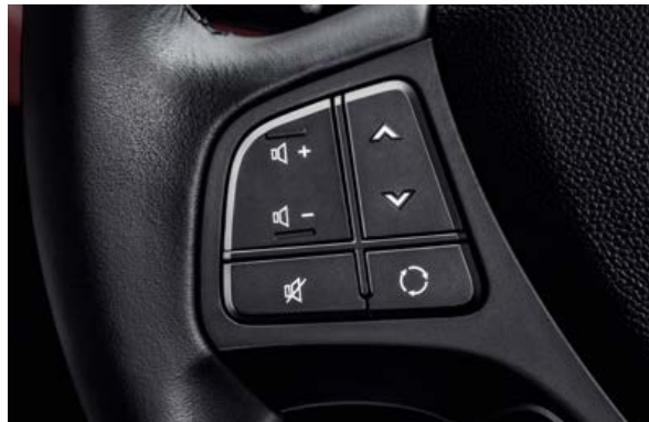
Audio-Fernbedienung 5 . Lautstärke, Sender- und Titelwechsel sind einfach an den Lenkradtasten zu regeln.
