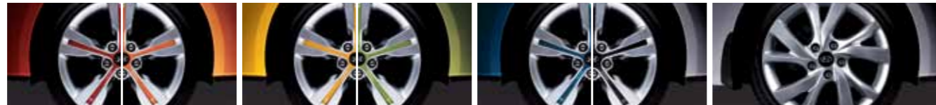
P225/40R18 타이어 & 18인치 컬러 인서트 하이퍼 실버 알루미늄 휠 (외장 컬러 크리스탈화이트, 소닉실버, 팬텀블랙, 커피빈, 미스티베이지의 경우 블랙 적용) P215/45R17 타이어 & 17인치 알루미늄 휠
